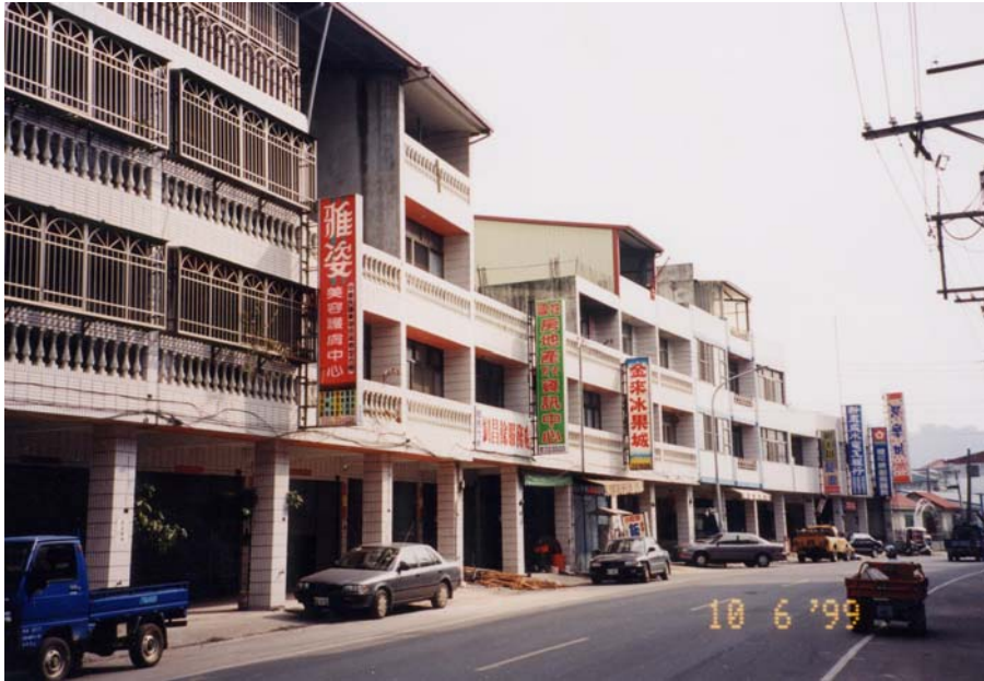
照片 2-9 具有平行騎樓方向牆壁之沿街店鋪住宅，受害輕微（三）
