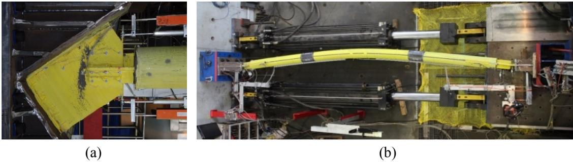
圖 15 G16 試體(a)南端接合板之凹折線及(b)整體撓曲挫屈
