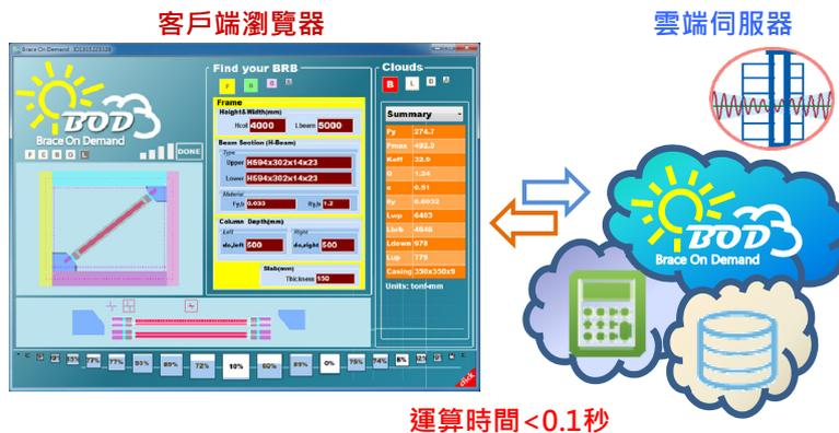
圖 21 BOD 客戶端瀏覽器與伺服器端互動架構示意圖
