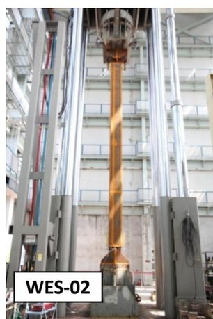
圖 22 (b) 構件 WES-02 使用建研所 2,000 噸萬能試驗機之試驗配置圖
