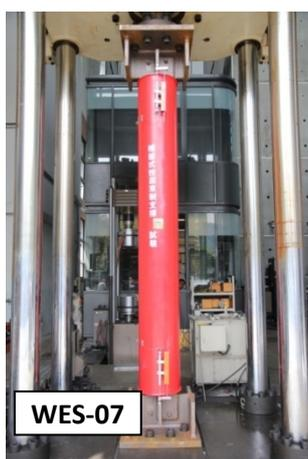
圖 22 (a) 構件 WES-07 使用國震中心 500 噸萬能試驗機之試驗配置圖
