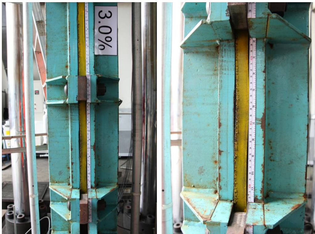
圖 7 核心鋼板高模態挫屈波長試驗觀測
