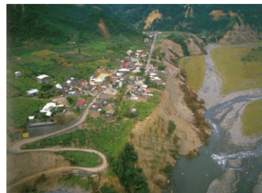
危險的河岸崖邊。崖邊在921集集地震中崩塌，使得上方的房子岌岌可危／照片來源：飛虎空中攝影
