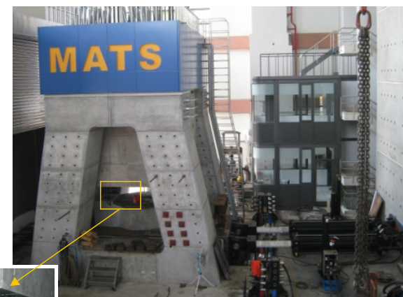
國家地震工程研究中心MATS試驗系統及測試中的隔震器
