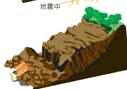
地震後崩塌的土石壓毀山坡下的房屋
