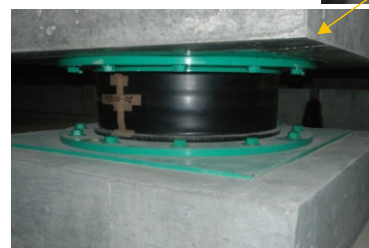
國家地震工程研究中心MATS試驗系統及測試中的隔震器
