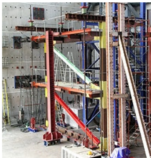
國家地震工程研究中心實驗場，正進行的斜撐減震器試驗
