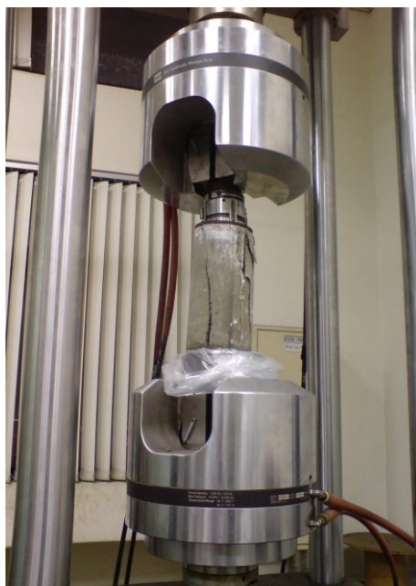
混凝土抗壓試驗
