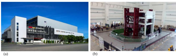
圖 1 (a) 國震中心台南實驗室 (b) 8 m × 8 m 振動台與三層樓鋼筋混凝土試體(白色部分)
