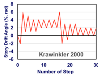
圖 1 AISC 341-16 遠域地震之鋼骨梁柱接合載重歷時
