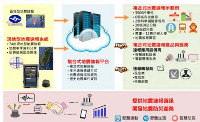
圖 1：複合式地震速報架構
