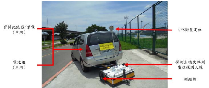
圖一 車載三維透地雷達檢測設備
