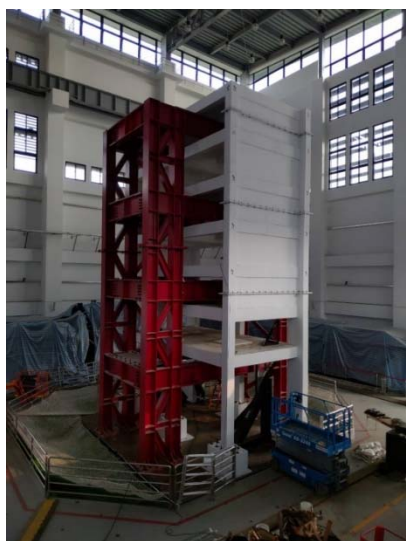
圖七 含軟弱層七層樓 RC 構架振動台試驗試體
