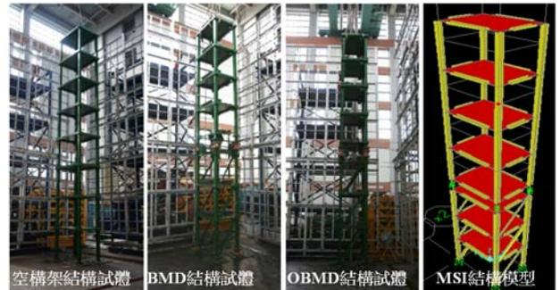
圖二 振動台試驗結構試體與數值分析模型
