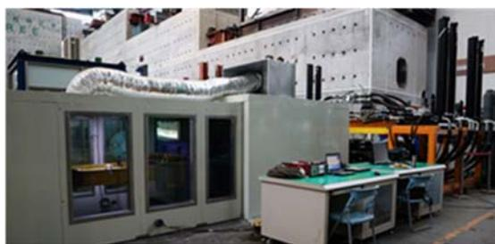
圖一 實尺寸黏彈性阻尼器受測試體與測試系統
