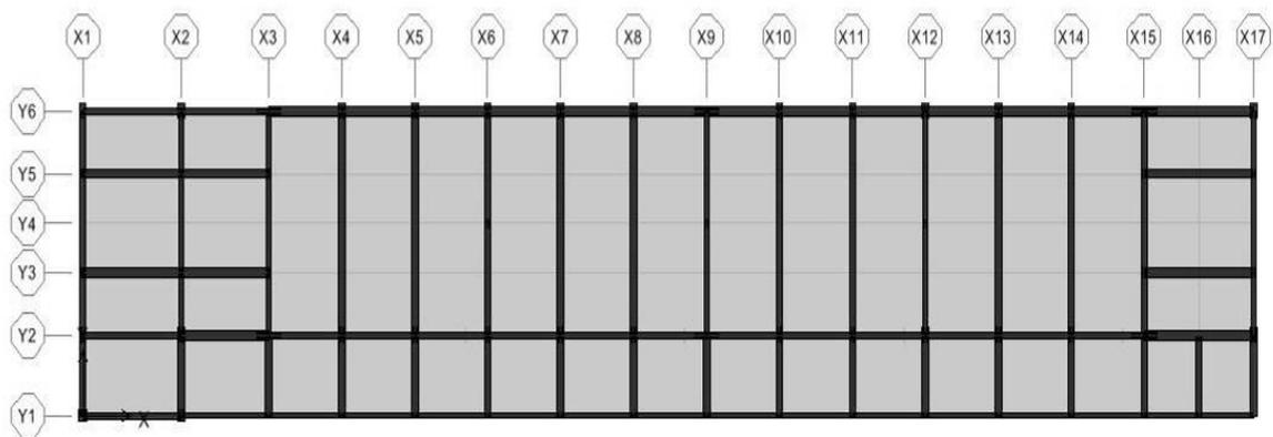
圖 C.109 案例校舍翼牆補強之 ETABS 結構分析模型平面圖
