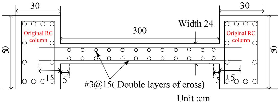
圖 5.10 剪力牆補強斷面示意圖
