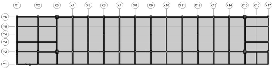
圖 C.96 案例校舍擴柱補強之 ETABS 結構分析模型平面圖
