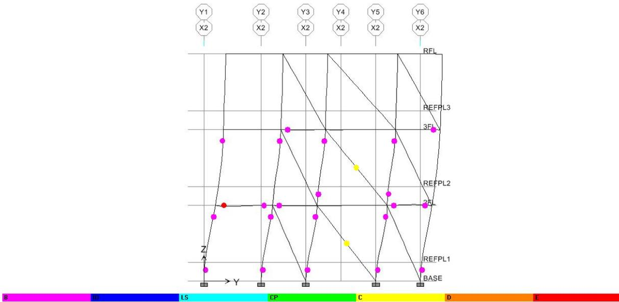
圖 C.77 Y 向之 X2 Frame(Deformed Shape-by PushX Static Nonlinear)
