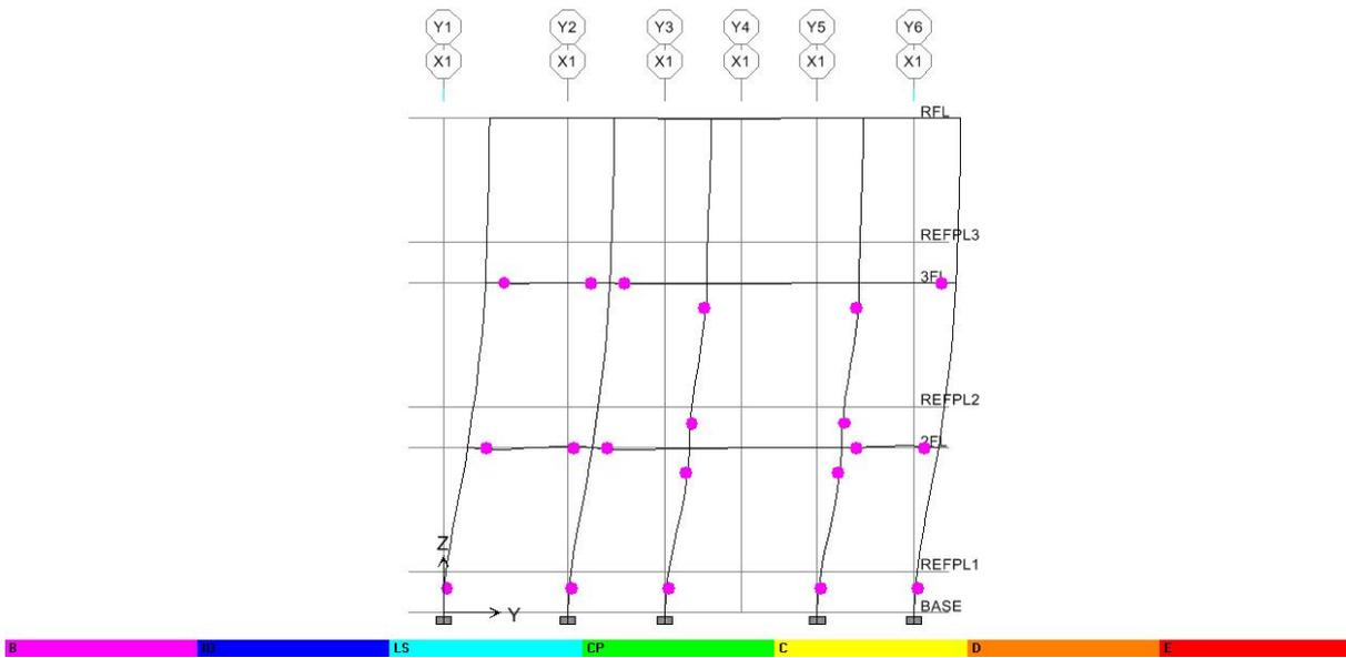
圖 C.76 Y 向之 X1 Frame(Deformed Shape-by PushX Static Nonlinear)
