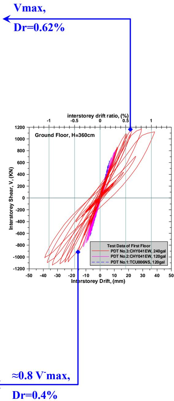
圖 2.1(c) 既有 RC 校舍結構擬動態試驗下之遲滯迴圈及損傷程度之關係比較 (Dr：一樓之層間變位比)
