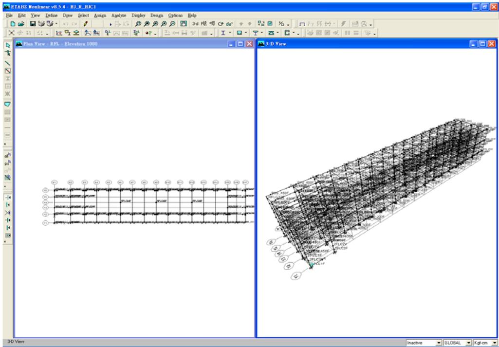
圖 C.98 案例校舍擴柱補強之 ETABS 程式 e2k 檔，檢查是否有非線性鉸產生
