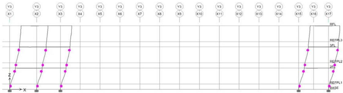
圖 C.65 X 向之 Y3 Frame(Deformed Shape-by PushX Static Nonlinear)
