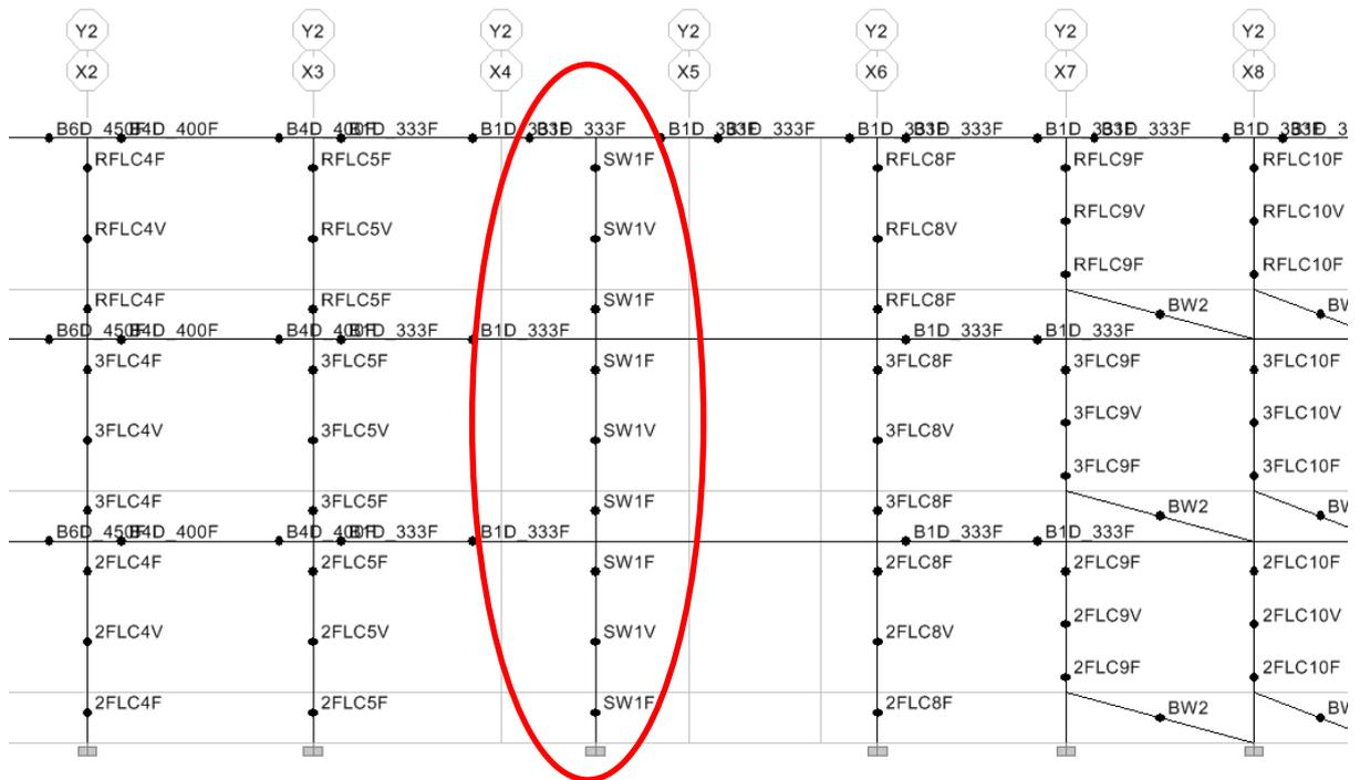
圖 C.121 指定剪力牆等值寬柱上的非線性鉸 (Y2 構架示意, Y6 構架同理)
