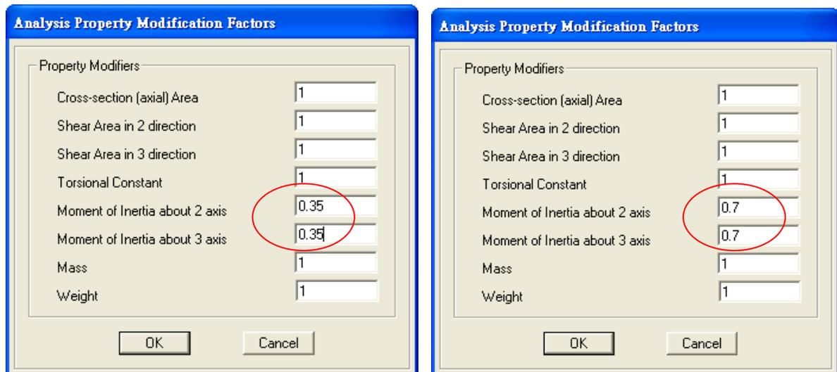
圖 C.23 案例校舍之梁、柱開裂勁度折減修改
