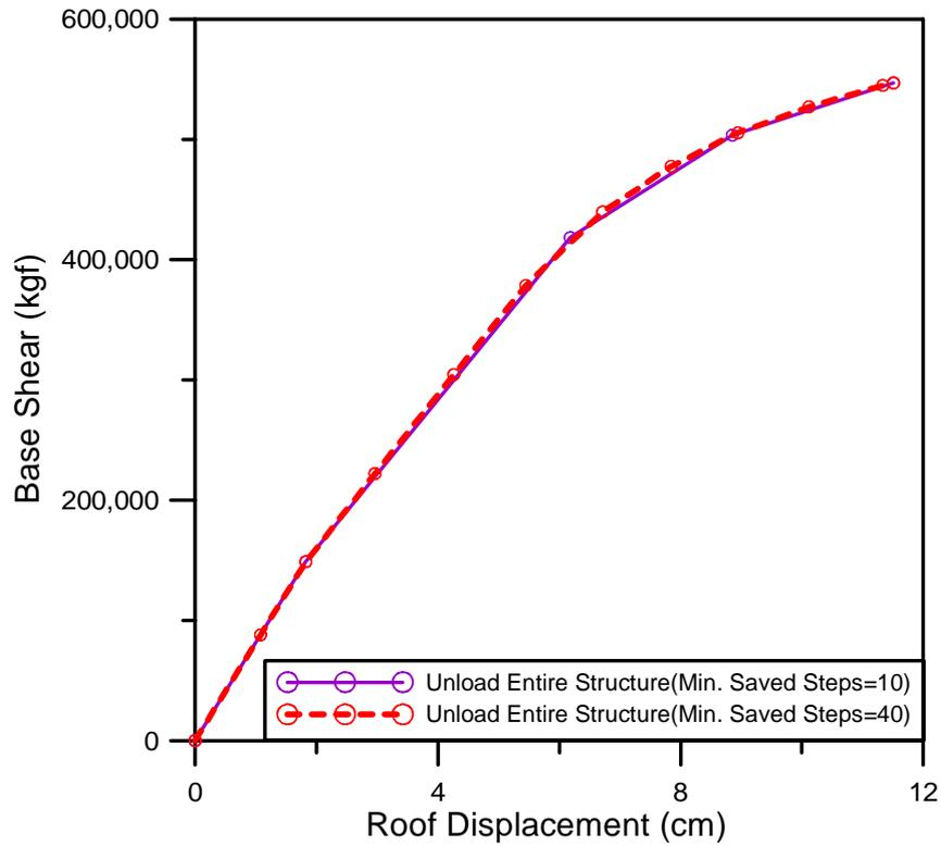
圖 C.135 調整非線性側推分析參數值前、後之容量曲線比較
