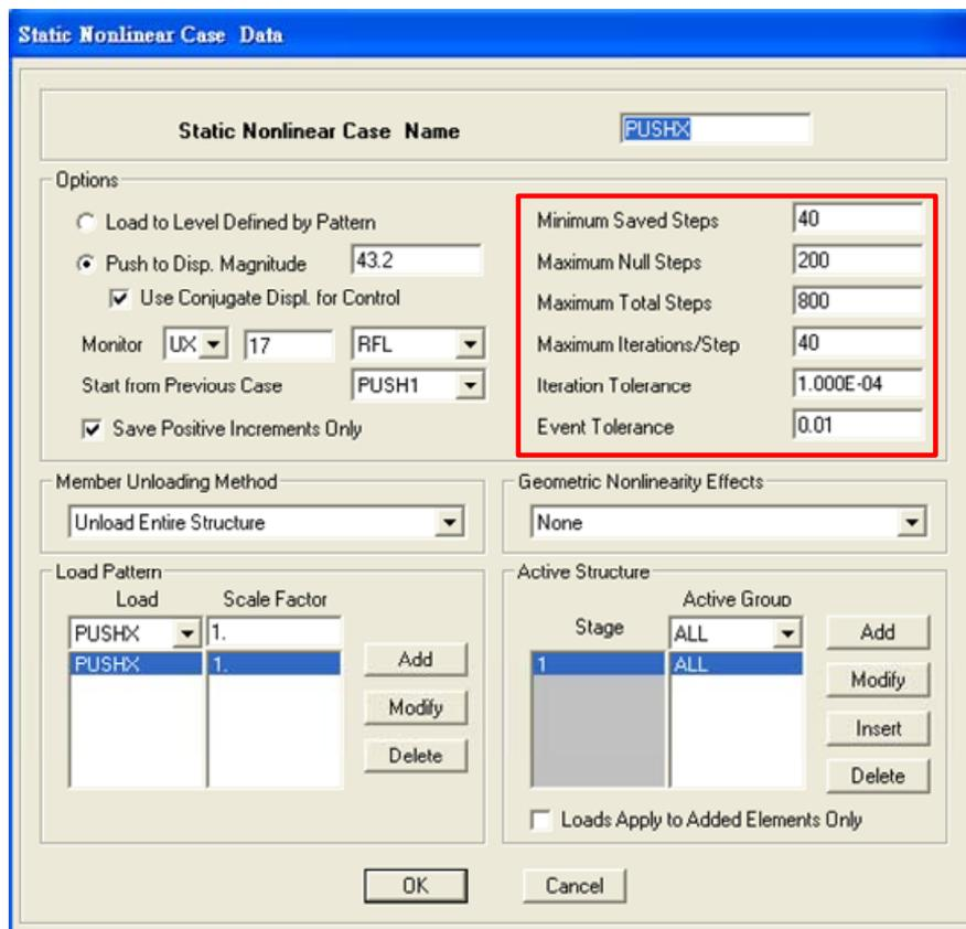
圖 C.134 非線性側推(PUSHX)中調整非線性側推分析參數值
