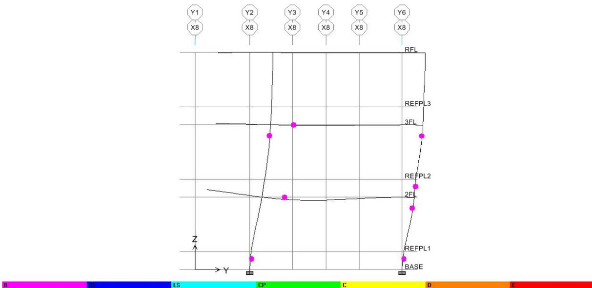
圖 C.83 Y 向之 X8 Frame(Deformed Shape-by PushX Static Nonlinear)
