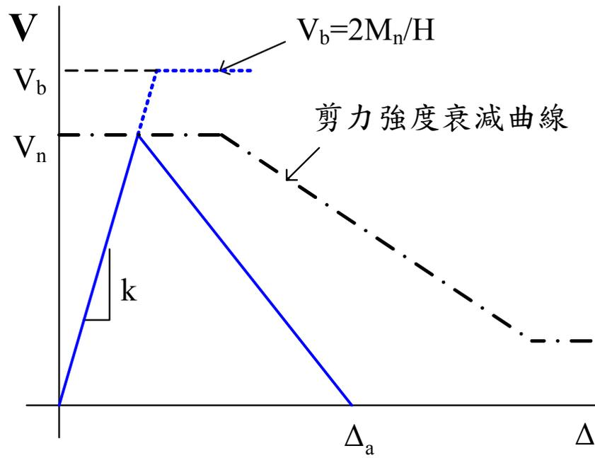
圖 4.7 剪力破壞側向載重位移曲線
