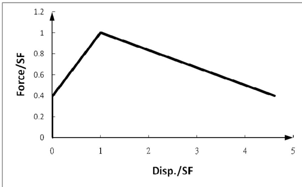
圖 5.12 RC 牆補強斷面之剪力非線性鉸(V2 Type)
