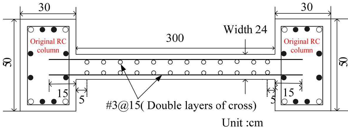
圖 C.117 案例校舍之剪力牆補強示意圖
