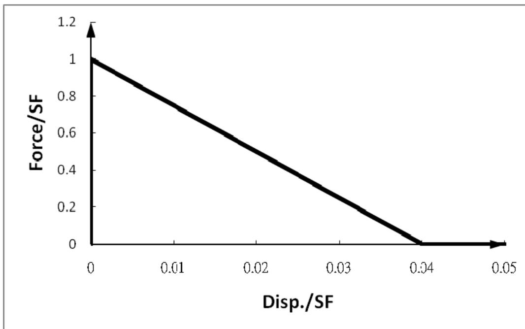
圖 5.6 RC 擴柱補強斷面之剪力非線性鉸(V2 Type)
