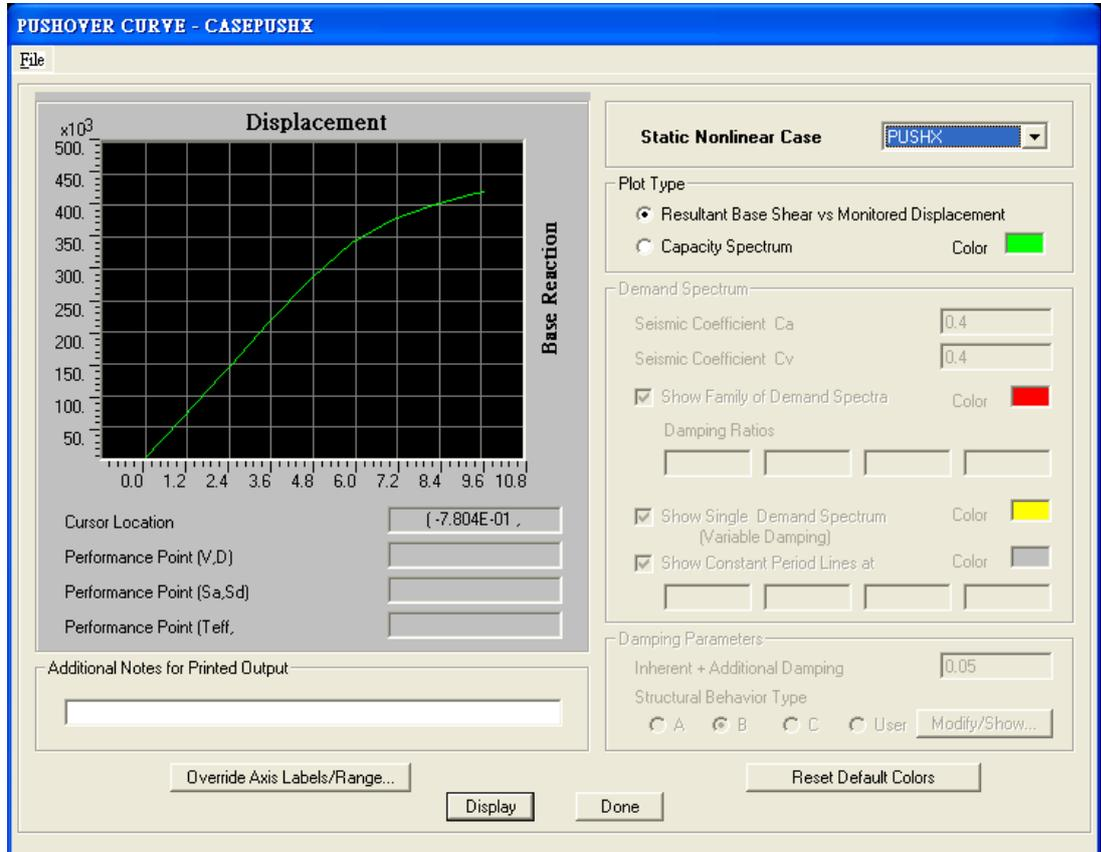
圖 C.49 案例校舍沿走廊方向容量曲線 (無下降端)
