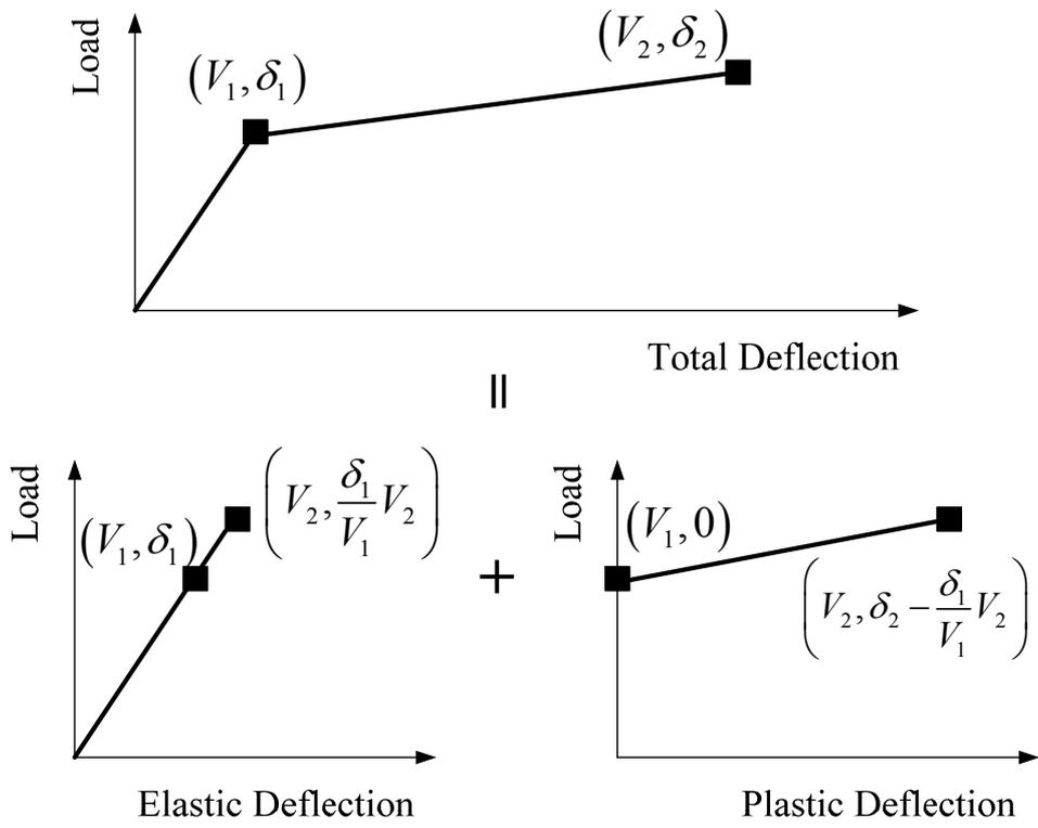
圖 4.14 彈性變位(左圖)與非線性變位(右圖)疊加示意圖
