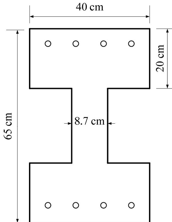
圖 5.17 複合柱含磚牆之轉換斷面
