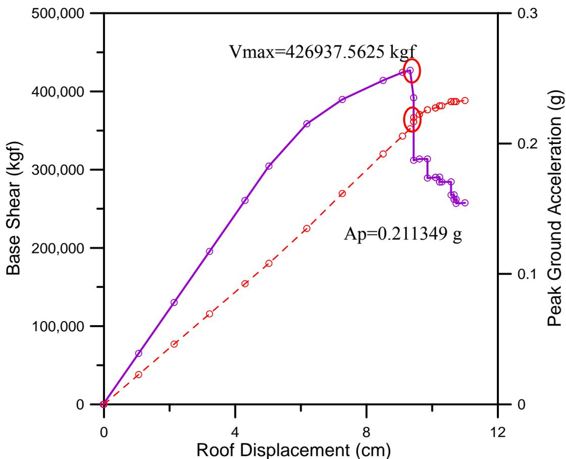
圖 C.69 X 向容量曲線圖及性能目標地表加速度圖(不含梁非線性鉸)
