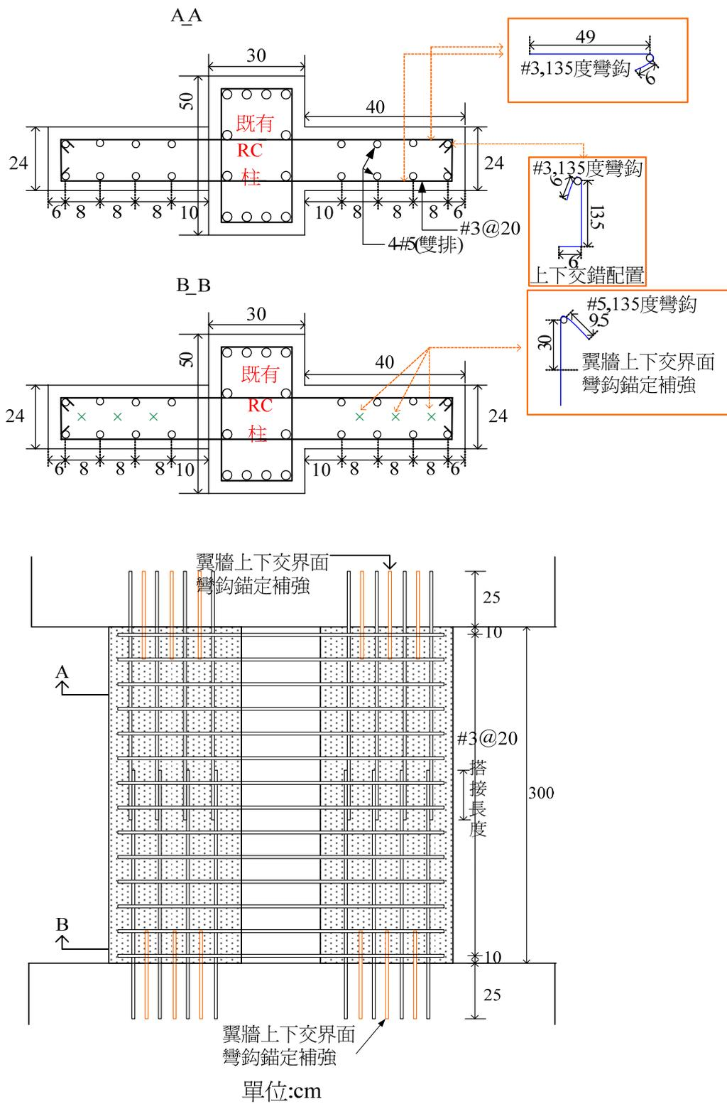
圖 5.7 翼牆補強斷面示意圖
