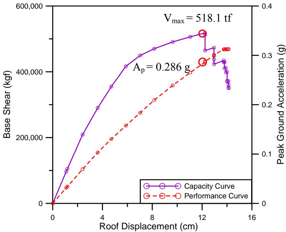
圖 C.103 採切割縫方式處理後所得之容量曲線圖及性能目標地表加速度圖
