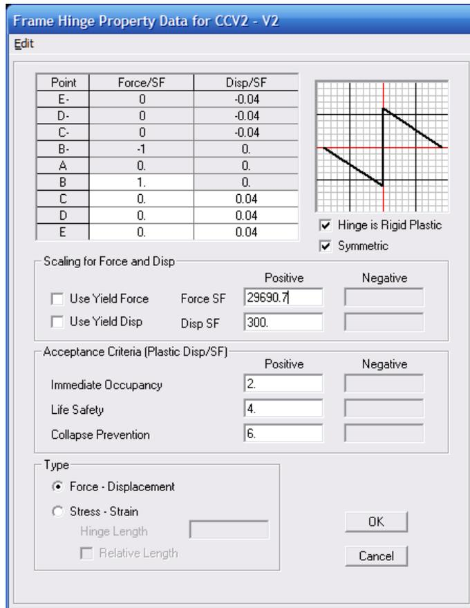
圖 C.131 複合柱斷面彎矩非線性鉸(CCV2)
