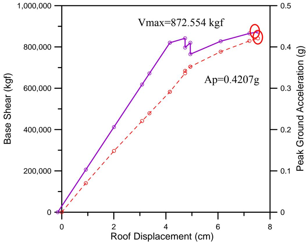
圖 C.74 Y 向容量曲線圖及性能目標地表加速度圖(不含梁非線性鉸)
