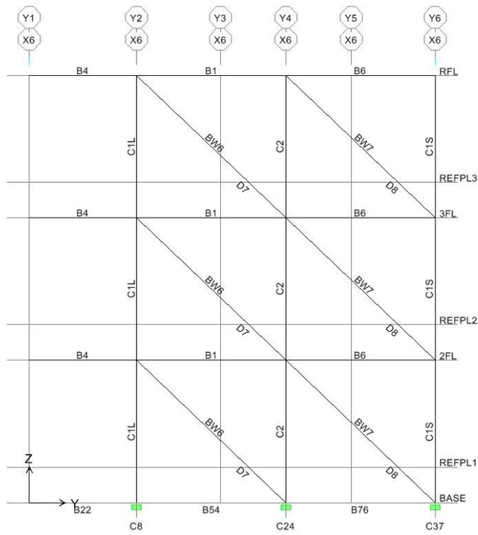
圖 C.14 短向 X-6 軸等值斜撐配置圖
