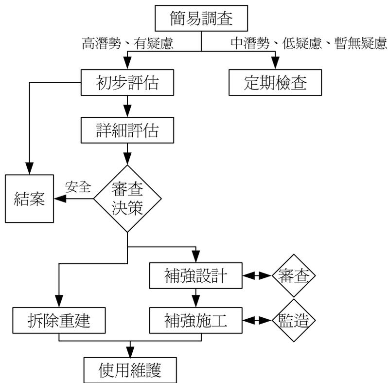
圖6.1 校舍耐震評估與補強流程圖
