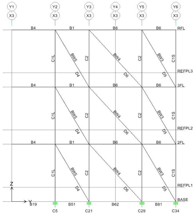
圖 C.13 短向 X-3 軸等值斜撐配置圖
