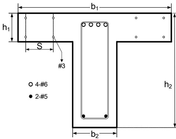
● 剪力牆等值寬柱斷面
