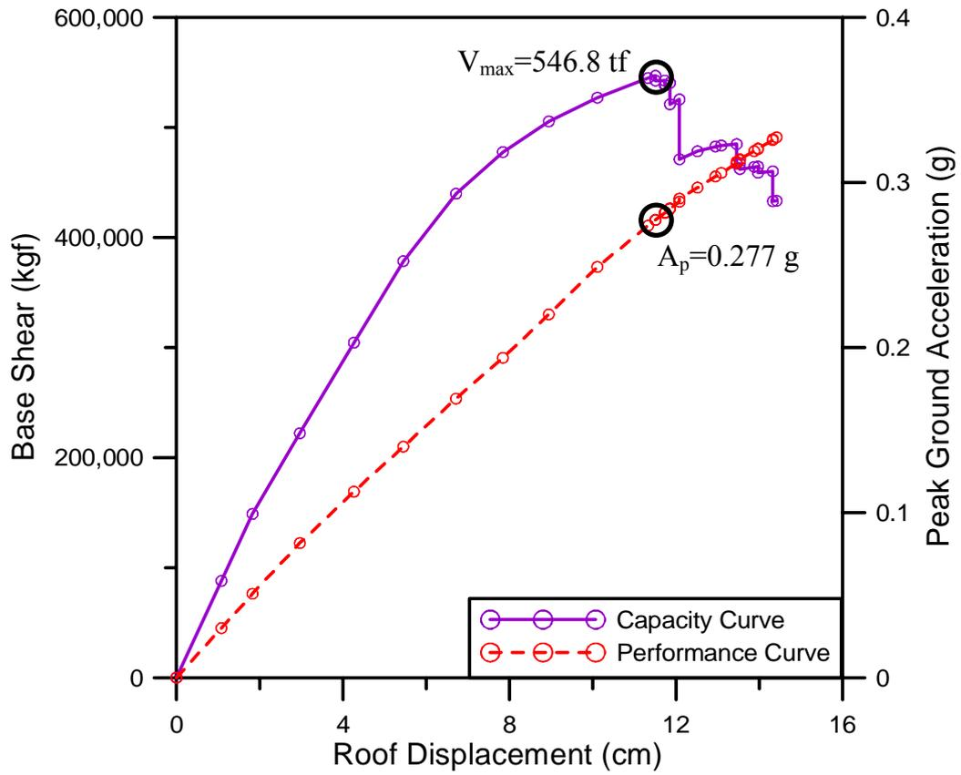
圖 C.137 採用二收斂方式所得結果之外包絡容量曲線與相應之性能曲線
