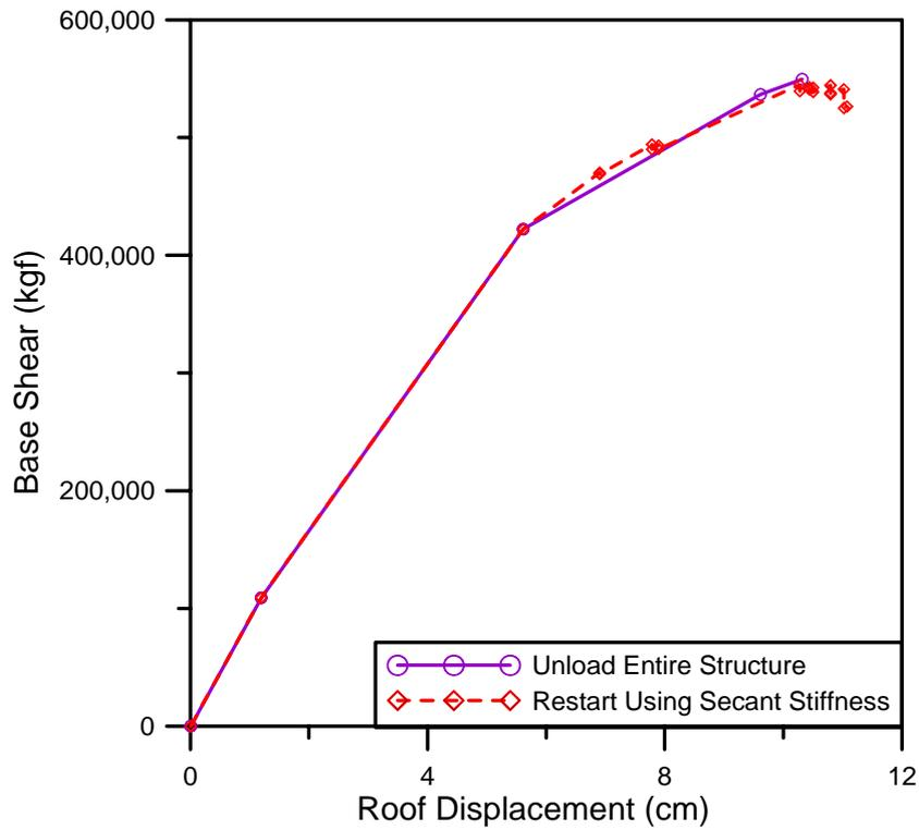
圖 C.102 採用不同收斂方式得到之容量曲線圖
