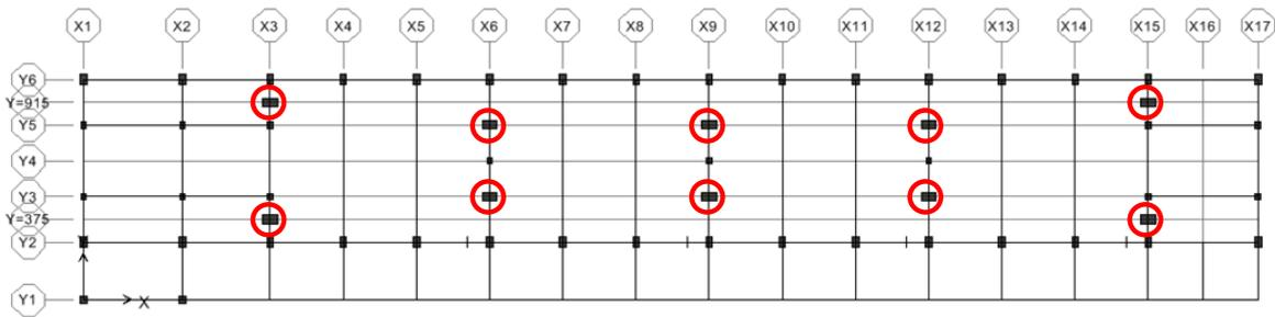
圖 C.124 案例校舍之複合柱補強位置平面圖
