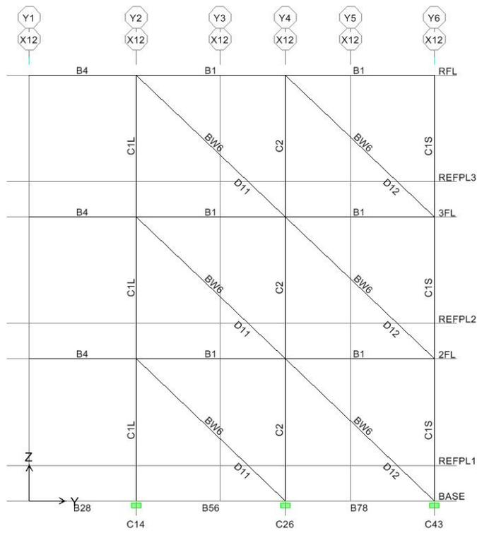
圖 C.16 短向 X-12 軸等值斜撐配置圖
