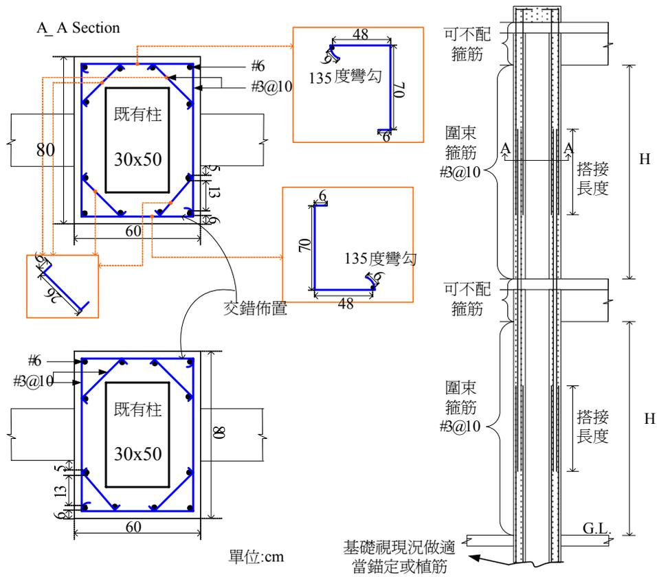
圖 C.94 案例校舍之擴柱補強示意圖
