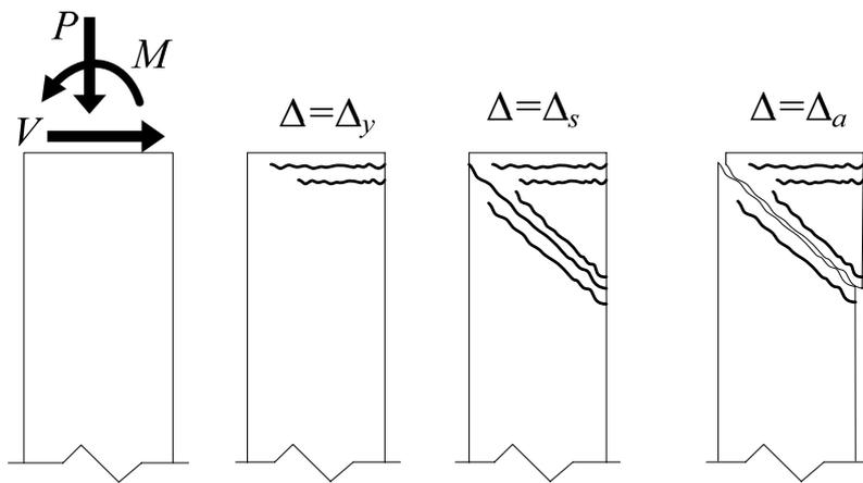
圖 4.3 雙曲率柱破壞發展過程
