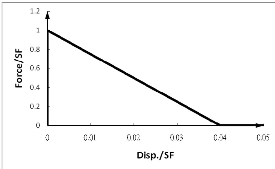
圖 5.9 RC 翼牆補強斷面之剪力非線性鉸(V2 Type)
