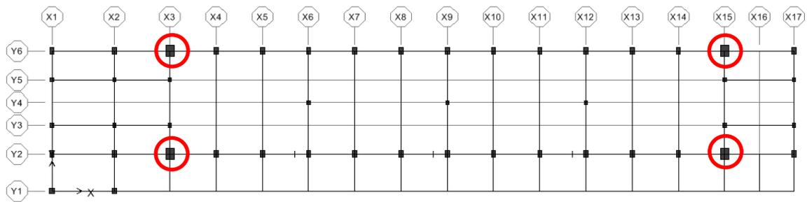
圖 C.93 案例校舍之擴柱柱補強位置平面圖
