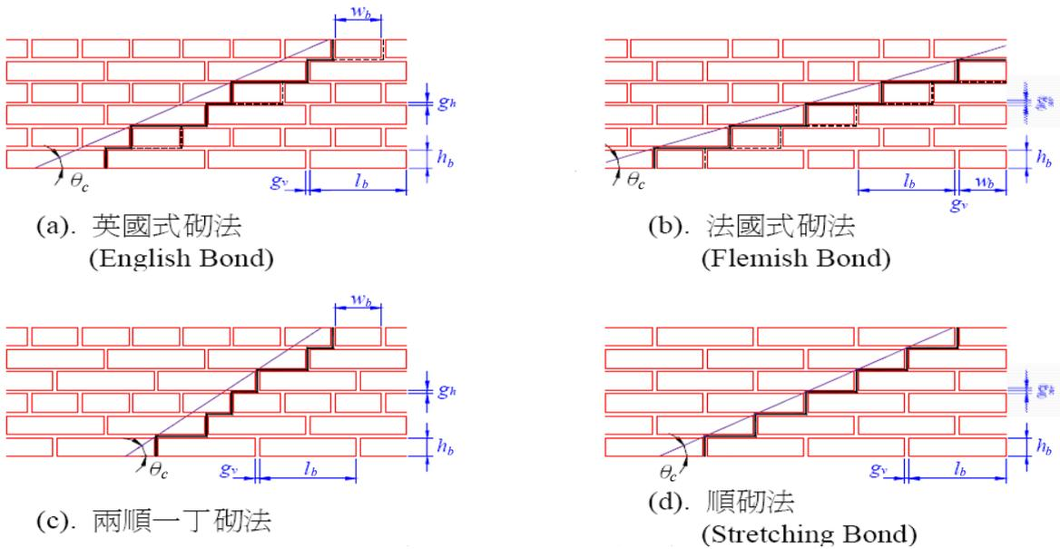
圖 4.21 各式磚牆砌法及臨界破壞角
