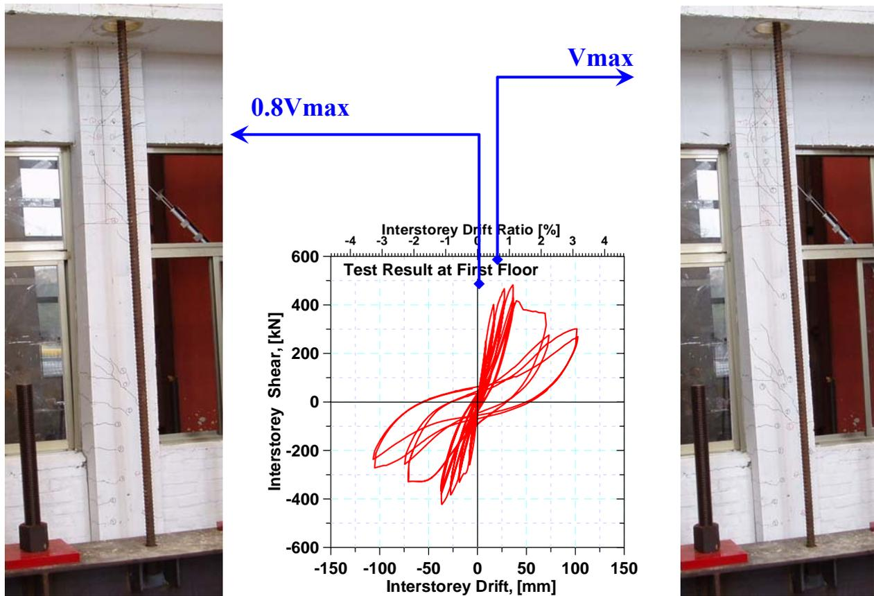
圖 2.1(a) 非韌性設計 RC 校舍構架反覆側推下之遲滯迴圈及損傷程度之關係比較(窗台柱)
