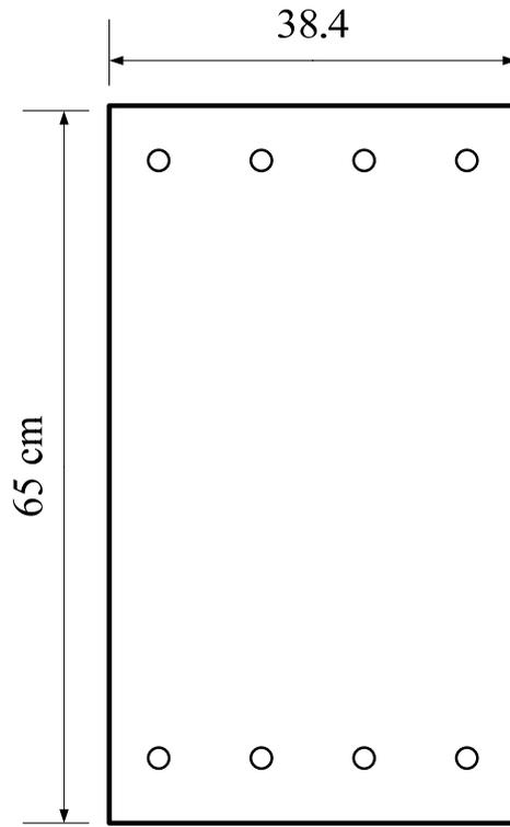
圖 C.127 複合柱轉換斷面之等效矩形斷面
