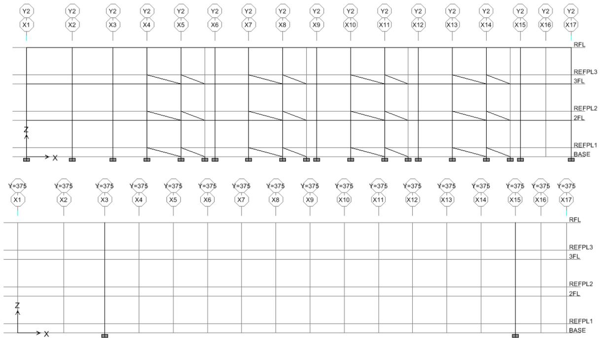
圖 C.129 案例校舍複合柱補強之 ETABS 結構分析模型立面圖
