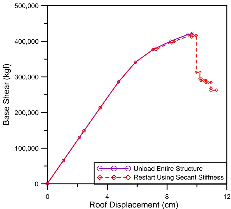
圖 C.51 採用不同收斂方式之容量曲線圖
