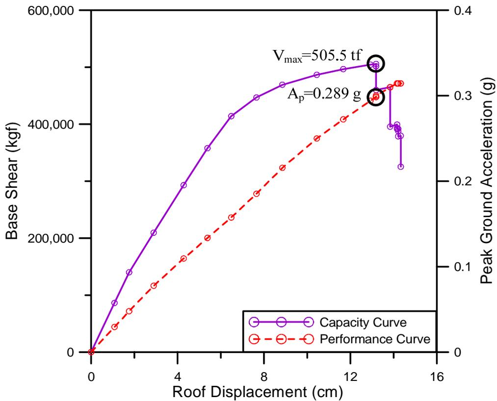
圖 C.140 底層柱與窗台間切割隔離縫後之外包絡容量曲線與相應之性能曲線
