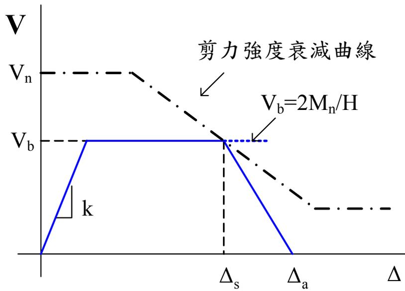
圖 4.5 撓剪破壞側向載重位移曲線
