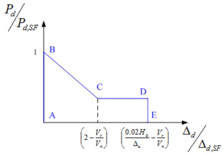
圖 4.24 磚牆等值斜撐之軸力非線性鉸性質
