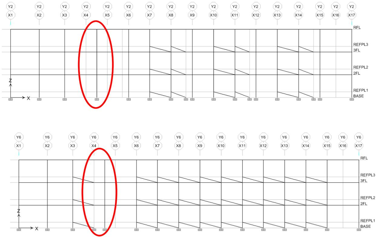
圖 C.119 案例校舍剪力牆補強之 ETABS 結構分析模型立面圖
