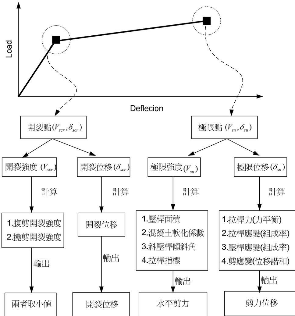
圖 4.19 剪力載重位移曲線計算流程圖
