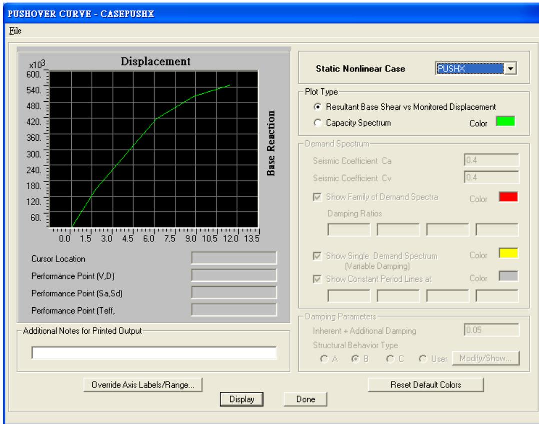
圖 C.133 案例校舍複合柱補強沿走廊方向容量曲線
