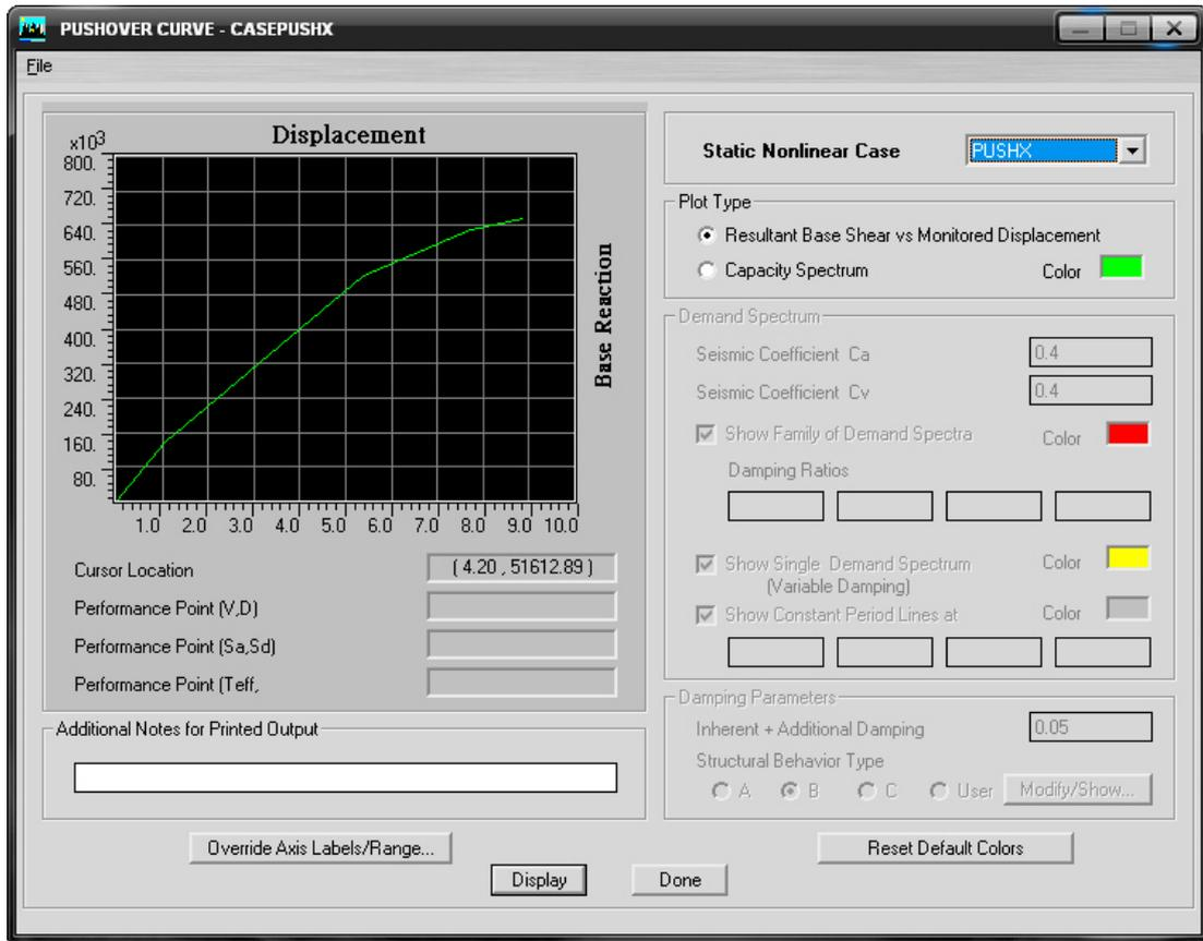
圖 C.112 案例校舍翼牆補強沿走廊方向容量曲線
