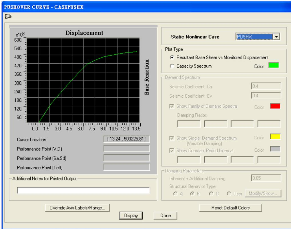
圖 C.139 最底層之柱與窗台間以切割隔離縫方式處理後之分析結果
