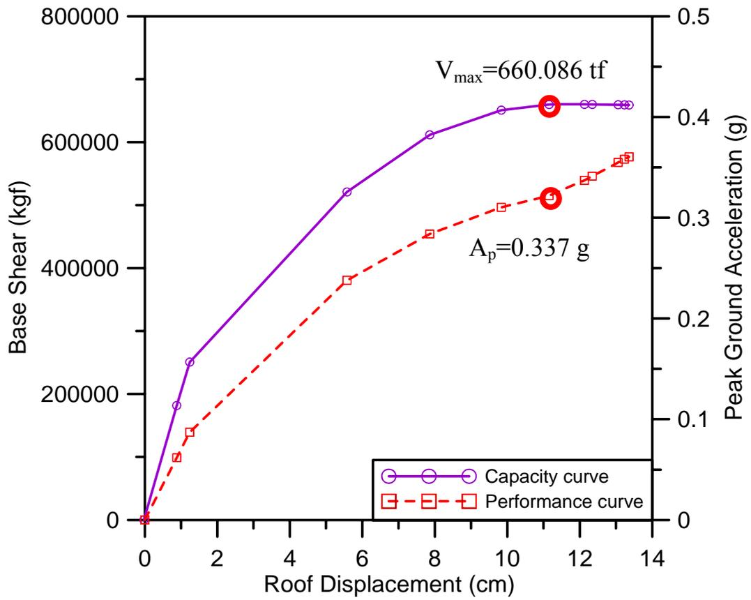
圖 C.123 案例校舍剪力牆補強容量曲線圖及性能目標地表加速度圖
