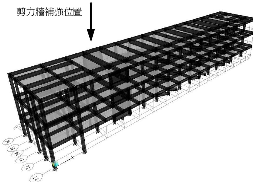
圖 C.118 案例校舍剪力牆補強之 ETABS 結構分析模型 3D 立體圖
