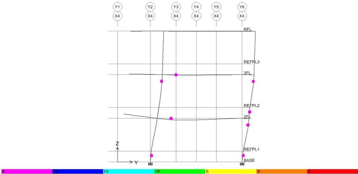
圖 C.79 Y 向之 X4 Frame(Deformed Shape-by PushX Static Nonlinear)
