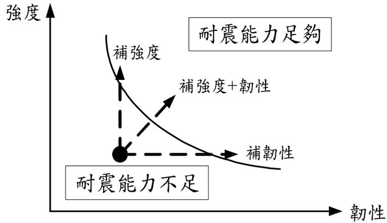
圖 5.1 補強原則示意圖
