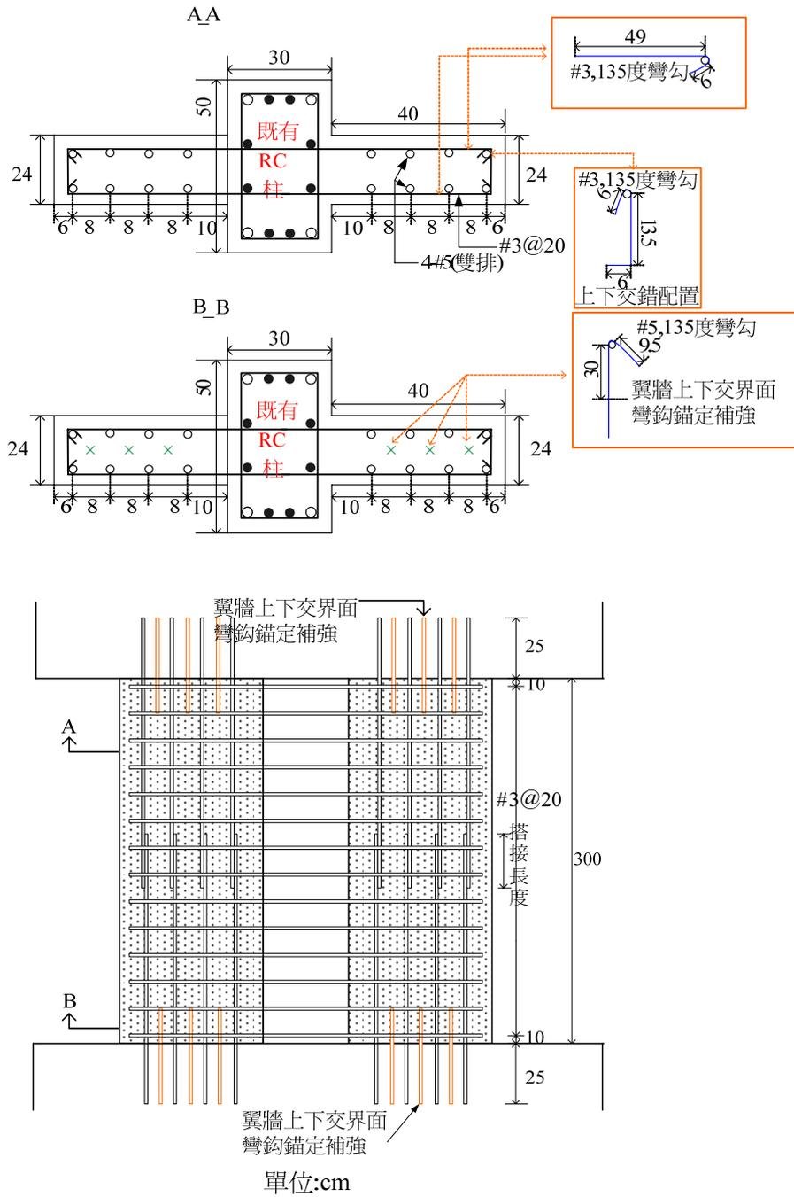
圖 C.107 案例校舍之翼牆補強示意圖
