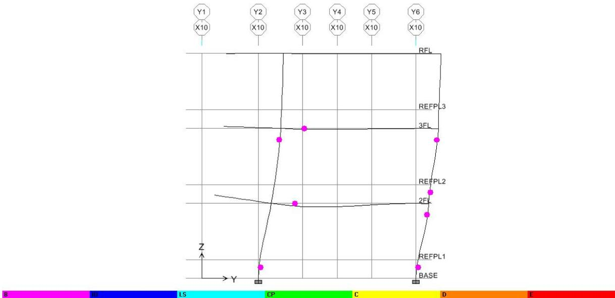
圖 C.85 Y 向之 X10 Frame(Deformed Shape-by PushX Static Nonlinear)
