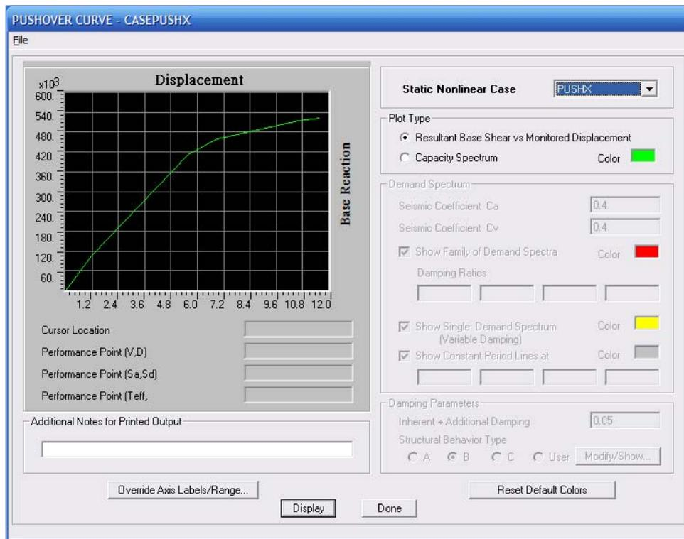
圖 C.99 案例校舍擴柱補強沿走廊方向容量曲線
