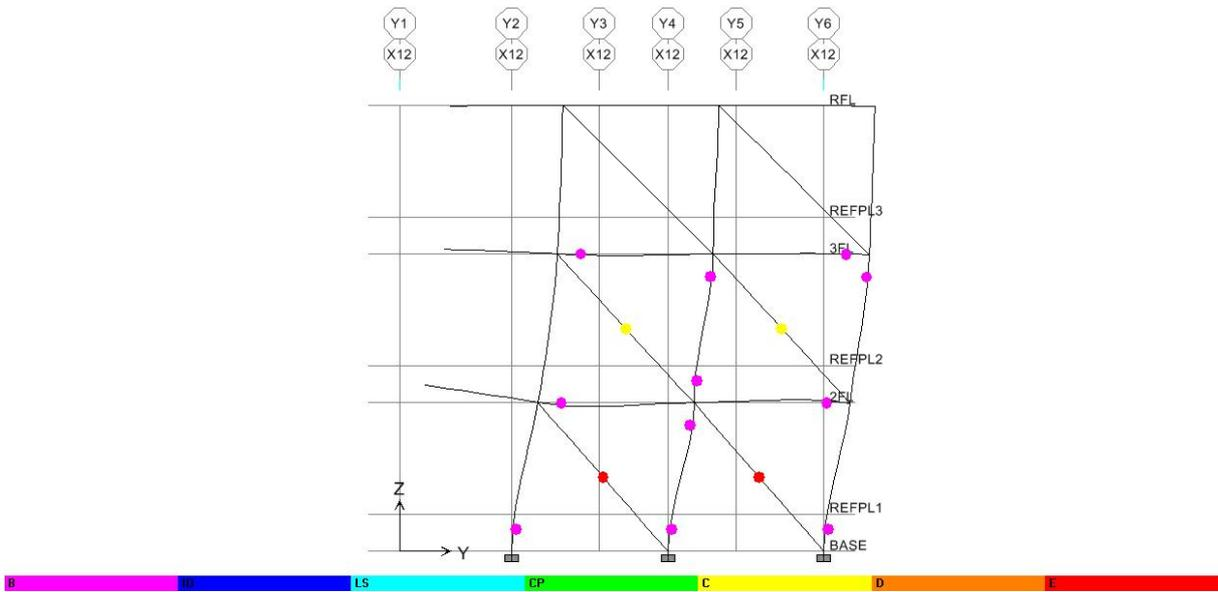
圖 C.87 Y 向之 X12 Frame(Deformed Shape-by PushX Static Nonlinear)
