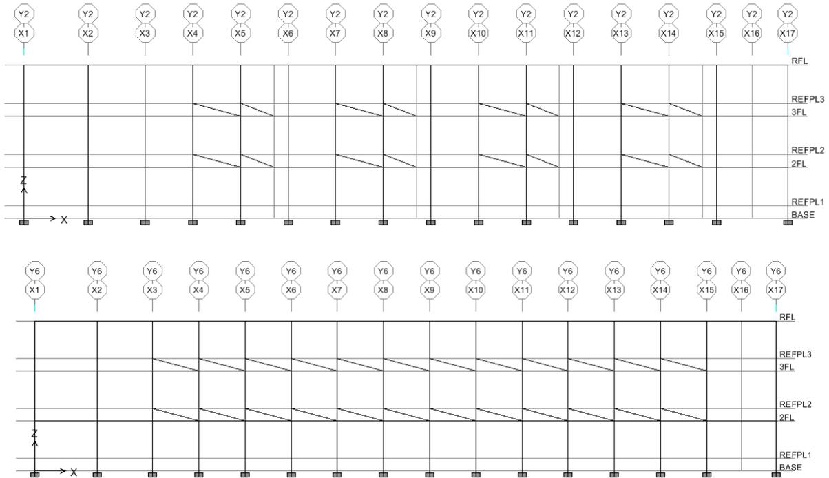
圖 C.138 將最底層之柱與窗台間以切割隔離縫方式處理情形
