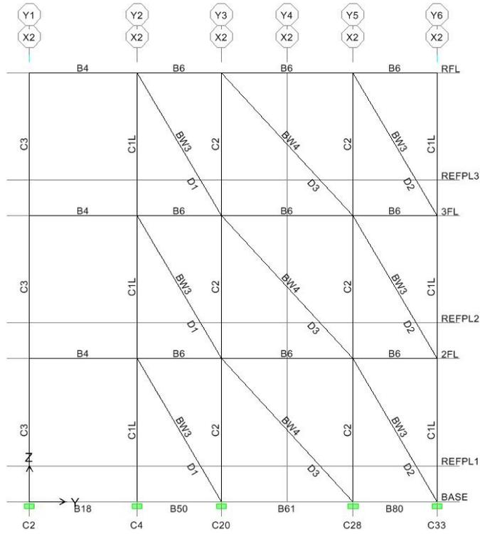
圖 C.12 短向 X-2 軸等值斜撐配置圖
