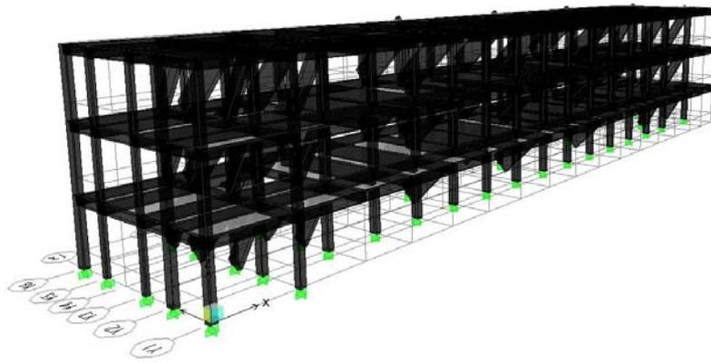
圖 C.70 案例校舍之 ETABS 結構分析模型 3D 立體圖
