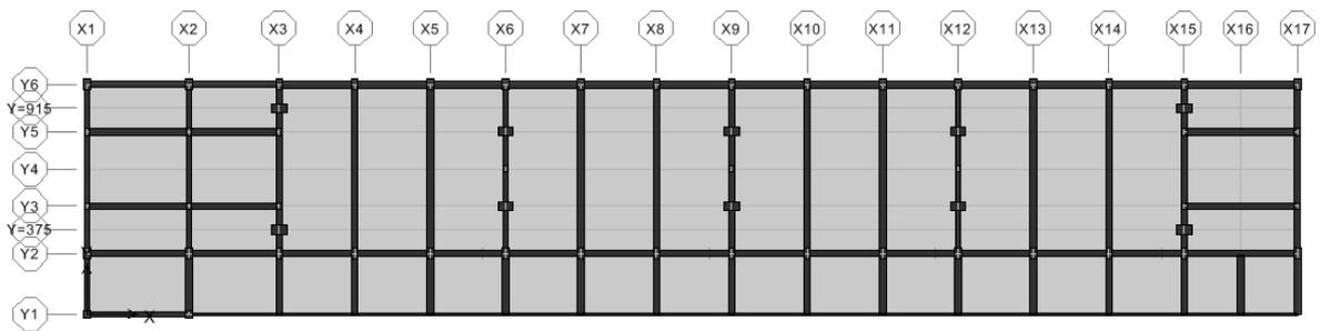
圖 C.128 案例校舍複合柱補強之 ETABS 結構分析模型平面圖
