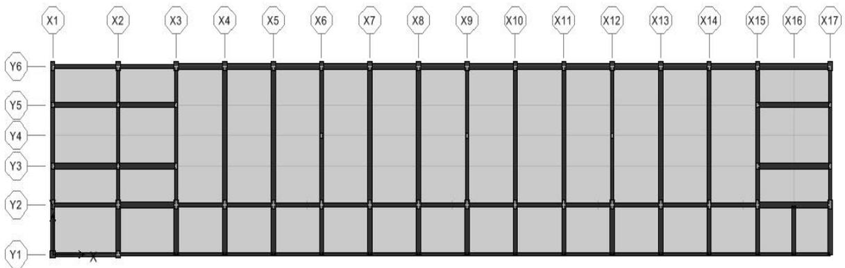
圖 C.20 案例校舍之 ETABS 結構分析模型平面圖
