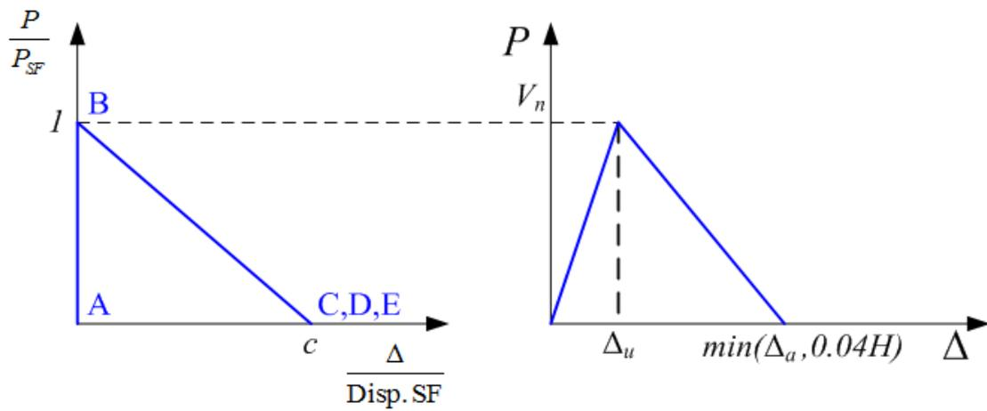
圖 4.10 剪力非線性鉸性質與側向載重位移曲線
