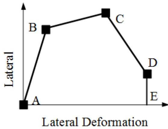
圖 4.16 RC 牆之側向載重位移曲線
