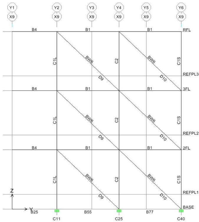
圖 C.15 短向 X-9 軸等值斜撐配置圖
