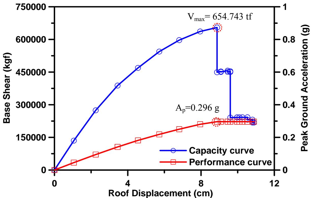
圖 C.115 案例校舍翼牆補強之容量曲線圖及性能目標地表加速度圖
