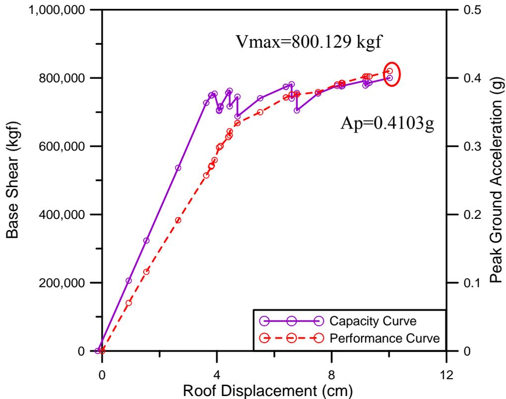
圖 C.75 Y 向容量曲線圖及性能目標地表加速度圖(含全部梁非線性鉸)
