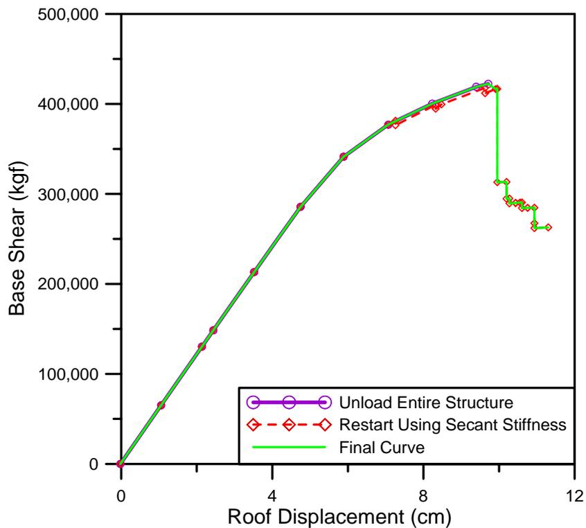
圖 C.52 採用不同收斂方式之容量曲線圖 (有外包絡線)
