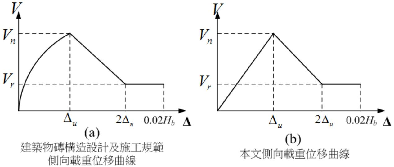
圖 4.22 磚牆之側向載重位移曲線
