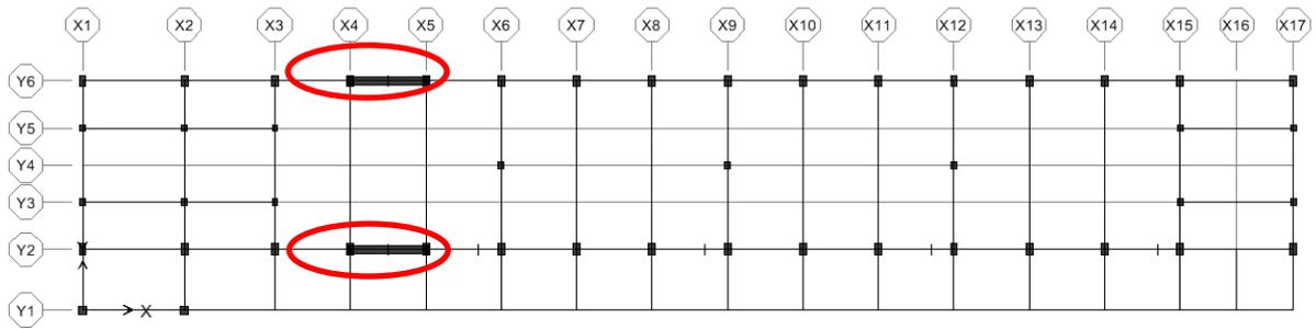
圖 C.116 案例校舍之剪力牆柱補強位置平面圖
