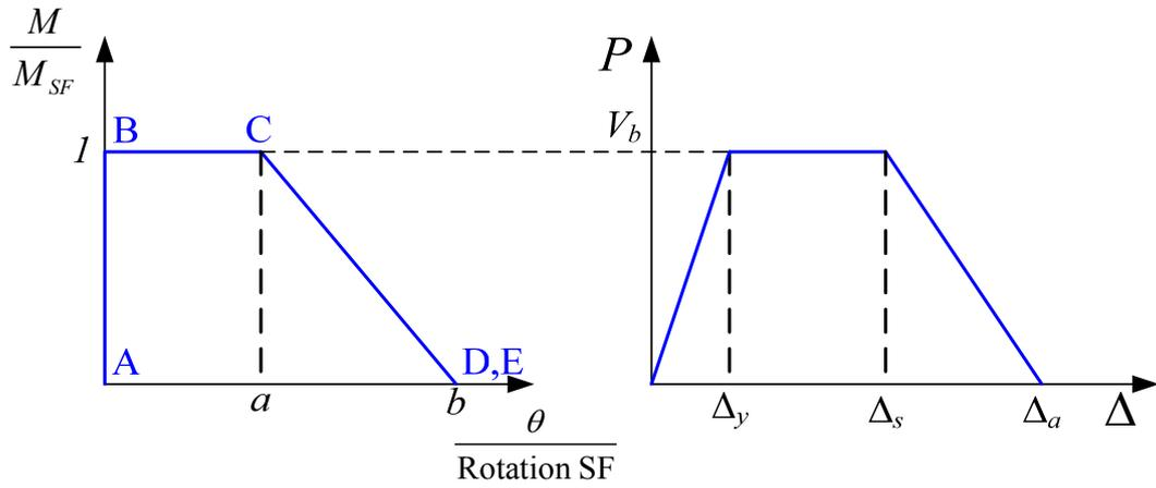
圖 4.9 彎矩非線性鉸性質與側向載重位移曲線
