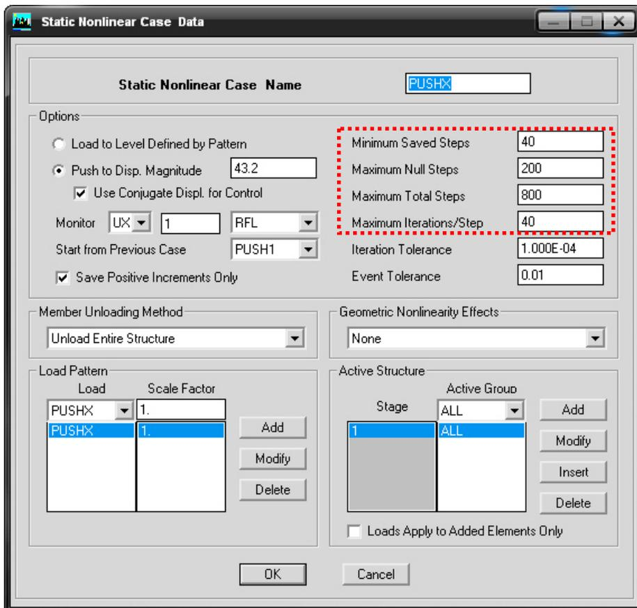
圖 C.113 非線性側推(PUSHX)載重型式之設定
