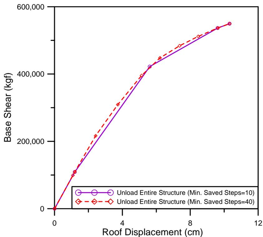
圖 C.101 調整非線性側推分析參數值後之容量曲線
