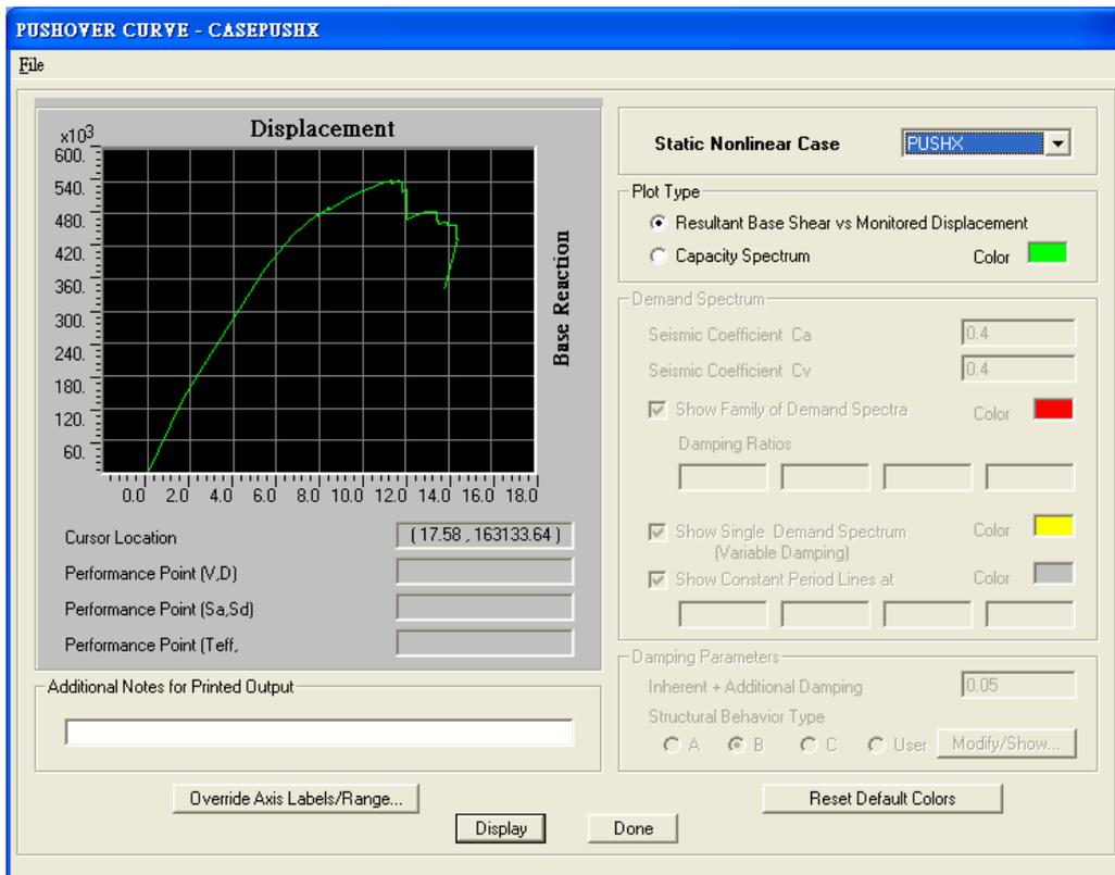
圖 C.136 採用「Restart Using Secant Stiffness」收斂方式之容量曲線
