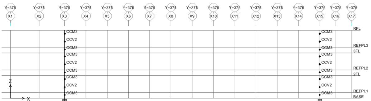
圖 C.132 案例校舍複合柱補強之非線性鉸設定
