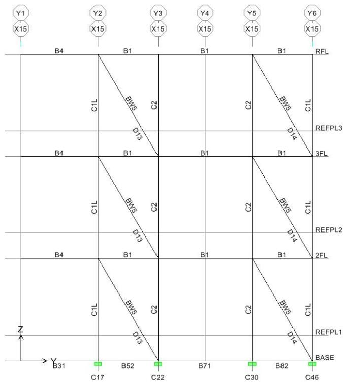
圖 C.17 短向 X-15 軸等值斜撐配置圖
