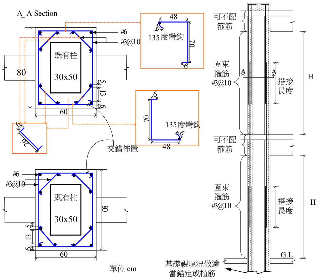
圖 5.4 擴柱斷面示意圖
