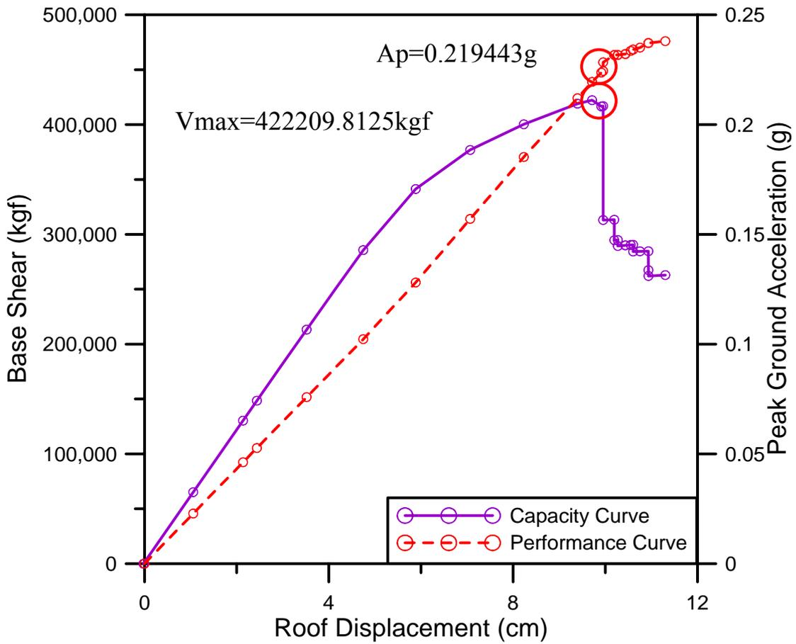
圖 C.62 X 向容量曲線圖及性能目標地表加速度圖(含梁非線性鉸)
