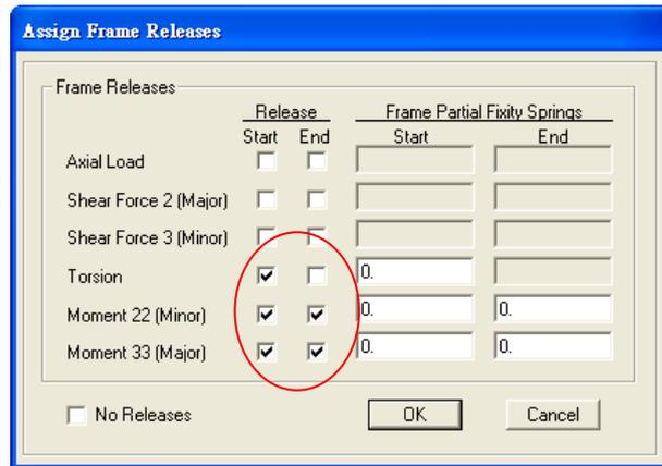
圖 C.46 案例校舍之等值斜撐彎矩釋放情形
