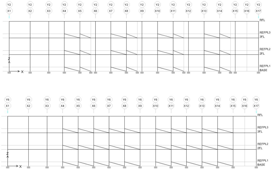
圖 C.97 案例校舍擴柱補強之建立結構模型(含牆構架)
