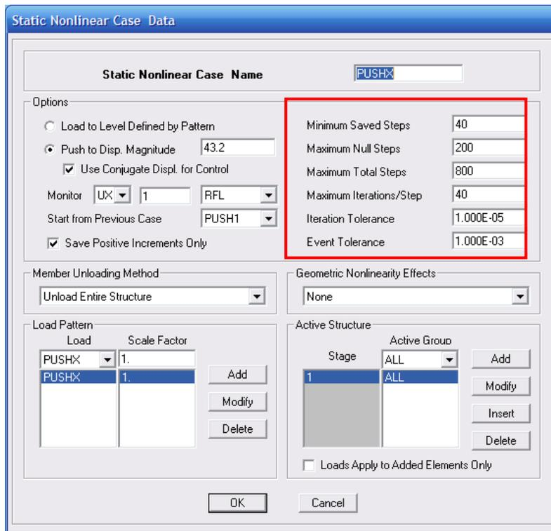
圖 C.100 非線性側推(PUSHX)載重型式之設定
