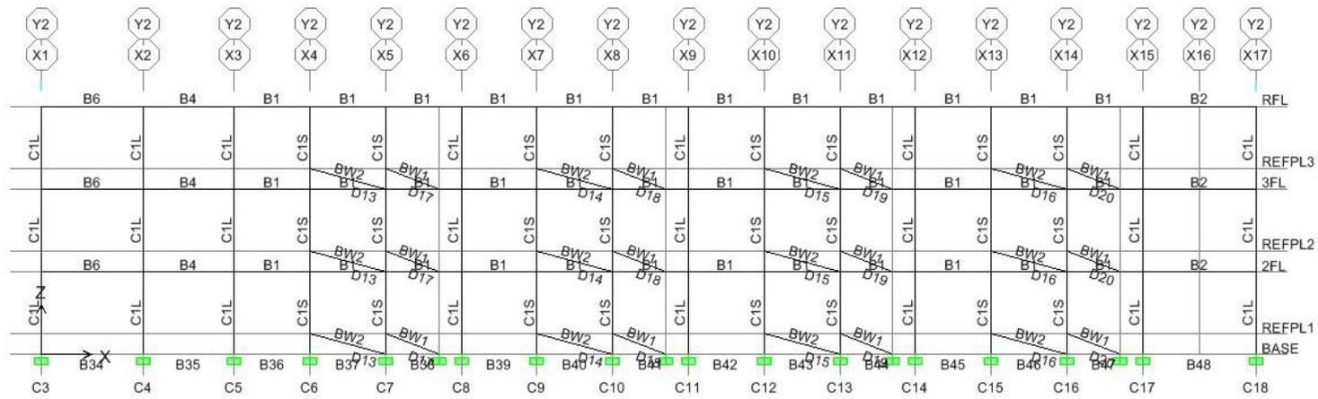
圖 C.10 長向 Y-2 軸等值斜撐配置圖
