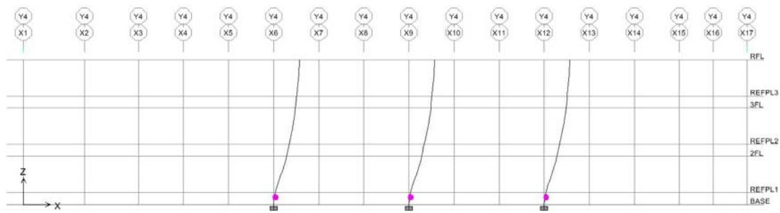
圖 C.66 X 向之 Y4 Frame(Deformed Shape-by PushX Static Nonlinear)
