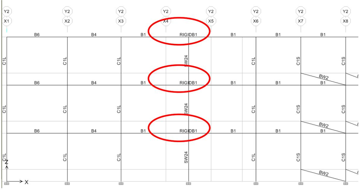
圖 C.122 剪力牆等值寬柱模型之剛性梁 (Y2 構架示意, Y6 構架同理)
