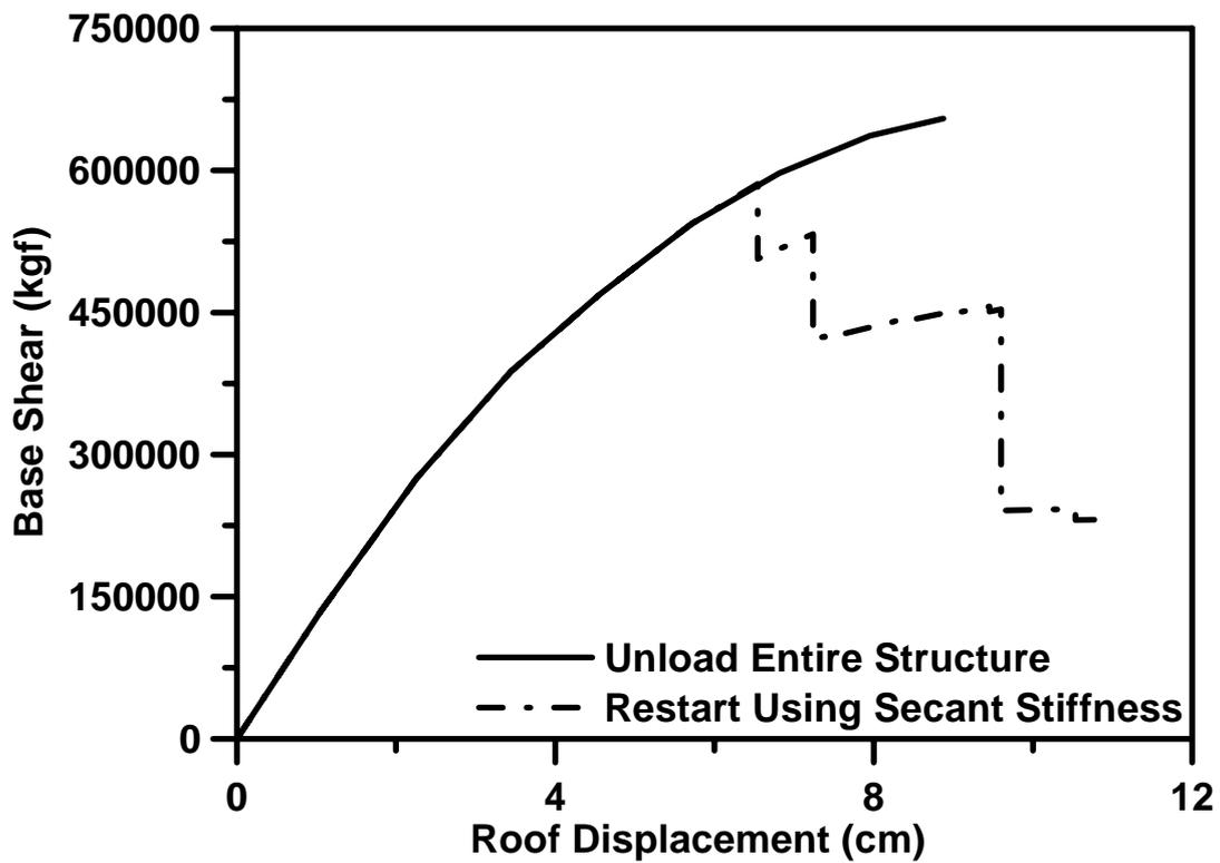
圖 C.114 採用不同收斂方式之容量曲線比較圖
