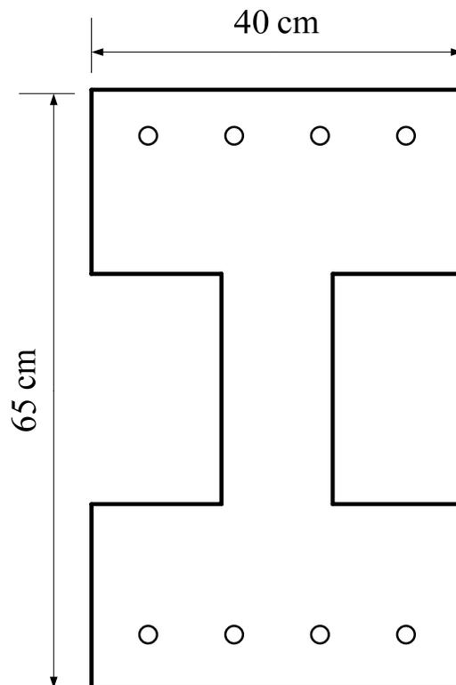
圖 C.126 複合柱(含磚牆)之等值轉換斷面
