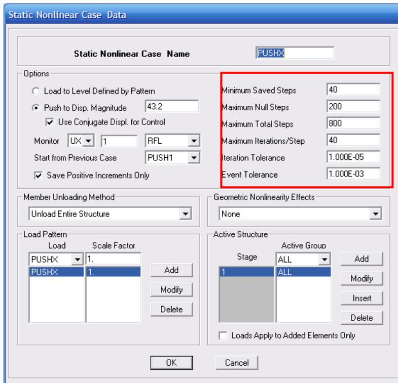
圖 C.50 非線性側推(PUSHX)載重型式之設定
