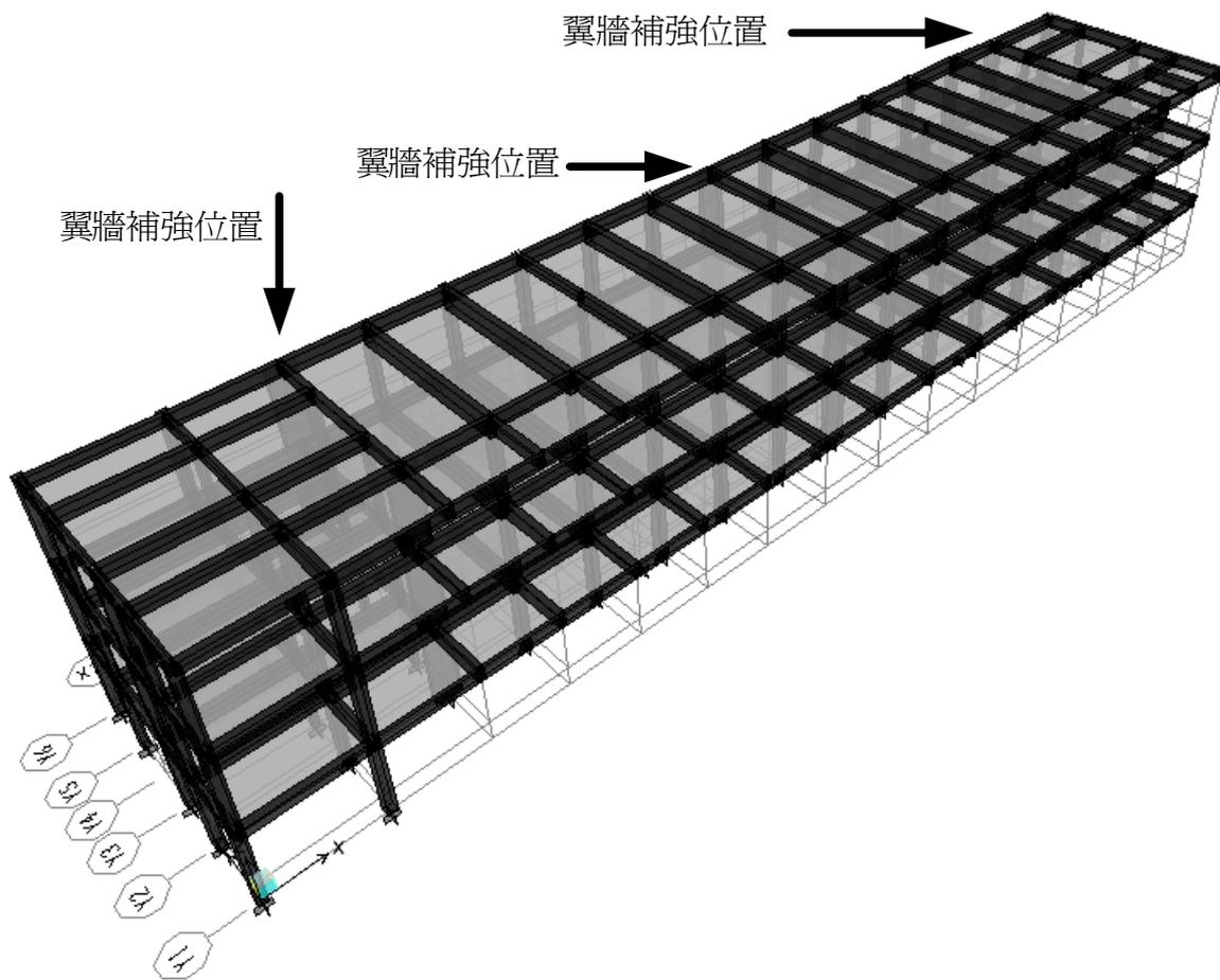
圖 C.108 案例校舍翼牆補強之 ETABS 結構分析模型 3D 立體圖
