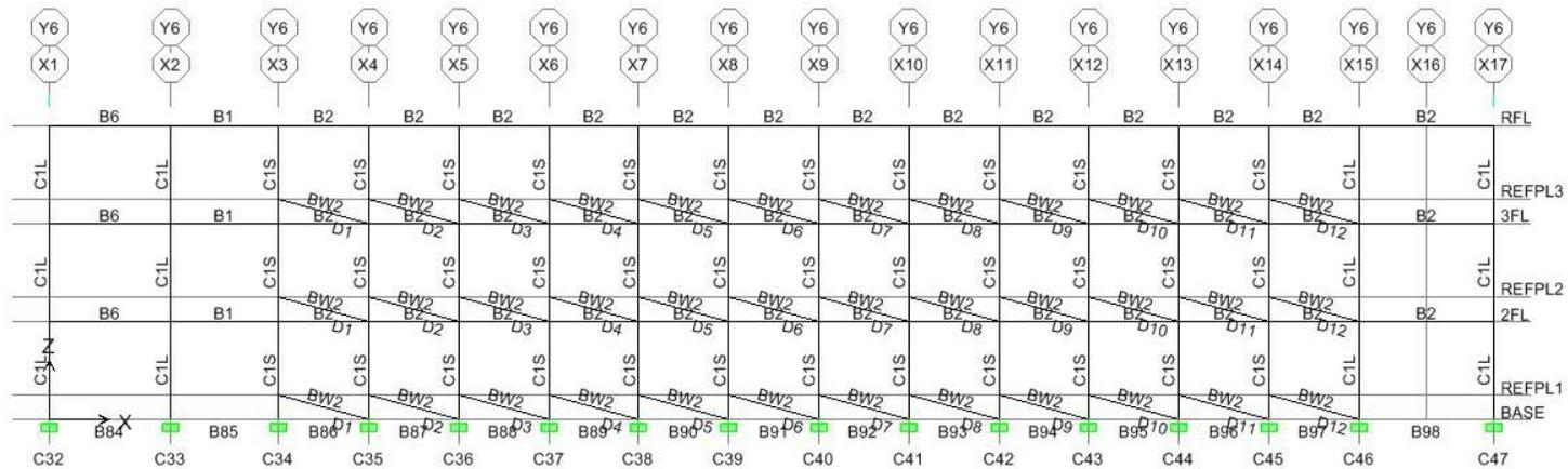
圖 C.11 長向 Y-6 軸等值斜撐配置圖
