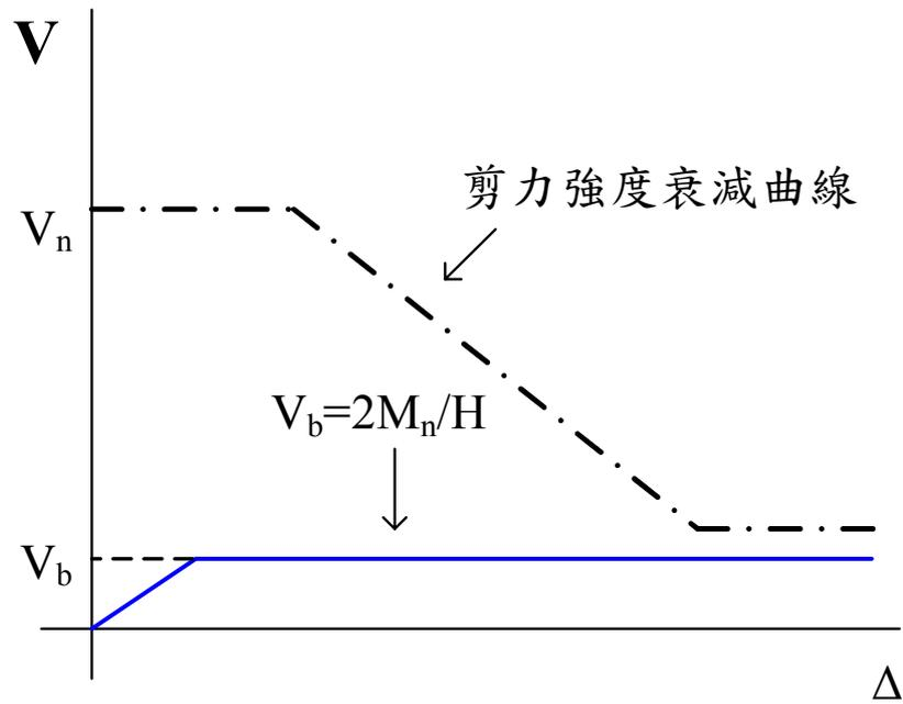
圖 4.8 撓曲破壞側向載重位移曲線
