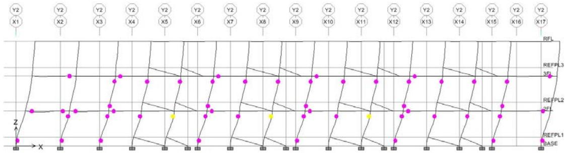
圖 C.64 X 向之 Y2 Frame(Deformed Shape-by PushX Static Nonlinear)
