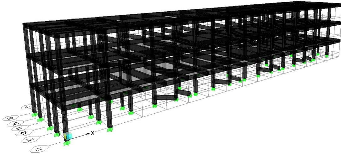
圖 C.19 案例校舍之 ETABS 結構分析模型 3D 立體圖
