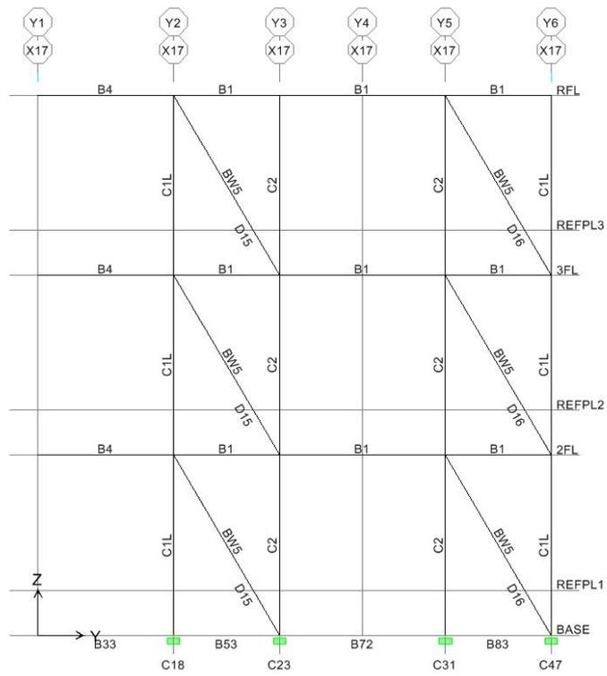
圖 C.18 短向 X-17 軸等值斜撐配置圖
