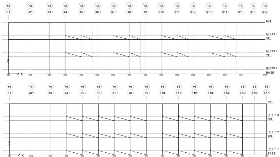
圖 C.110 案例校舍翼牆補強之建立結構模型(含牆構架)
