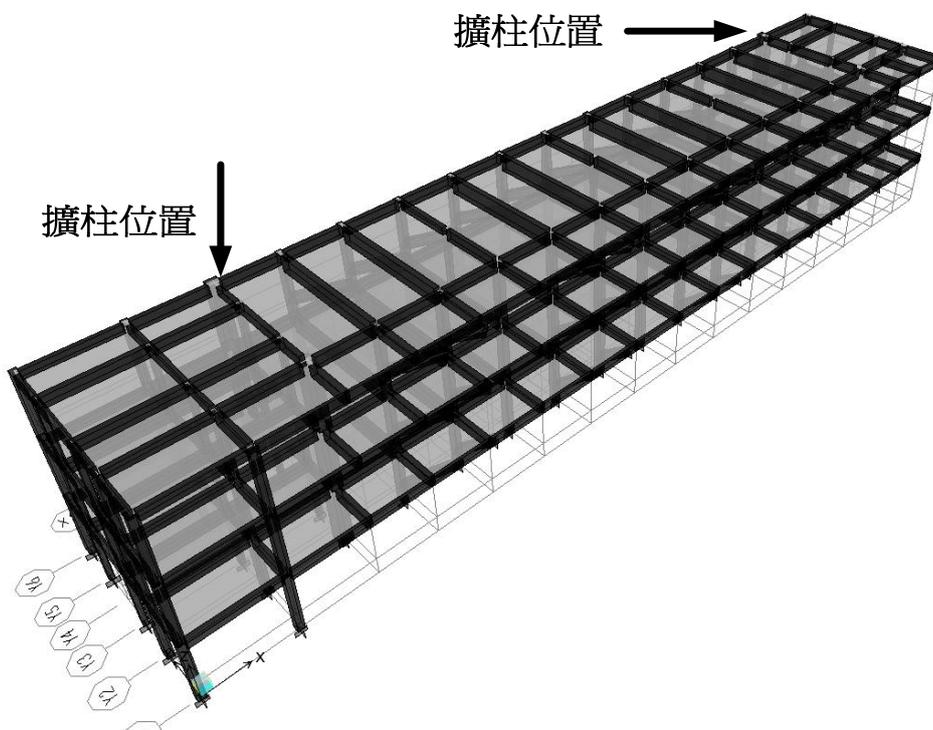
圖 C.95 案例校舍擴柱補強之 ETABS 結構分析模型 3D 立體圖
