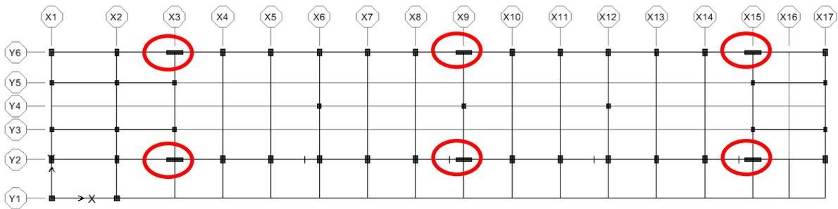
圖 C.106 案例校舍之翼牆柱補強位置平面圖
