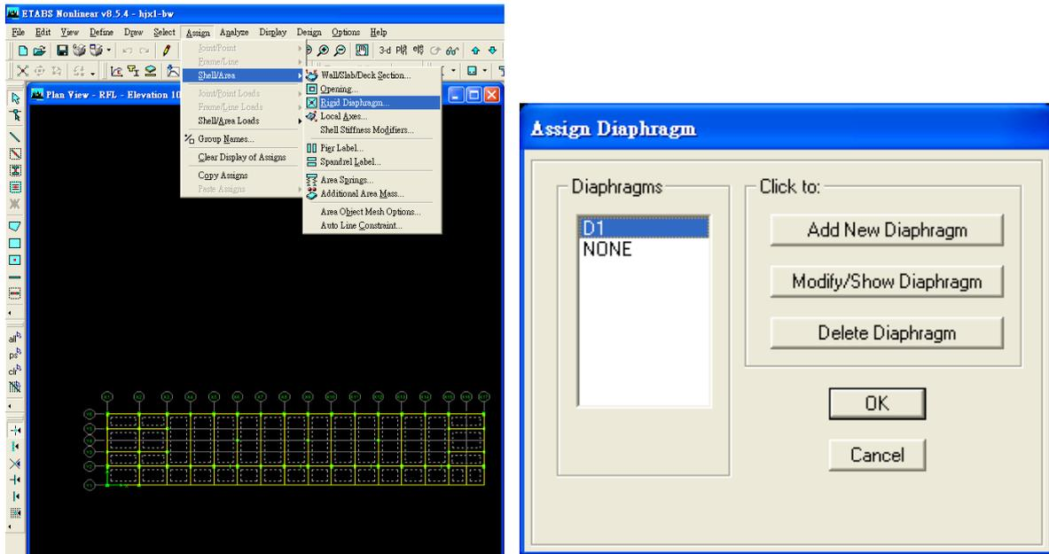
圖 C.21 案例校舍之 ETABS 結構分析模型刚性樓版設定
