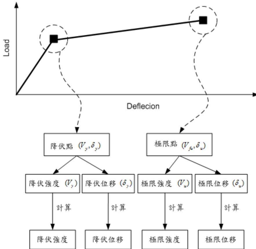
圖 4.15 撓曲與滑移載重位移曲線計算流程圖
