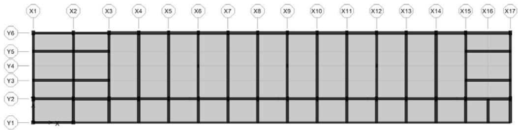
圖 C.71 案例校舍之 ETABS 結構分析模型平面圖
