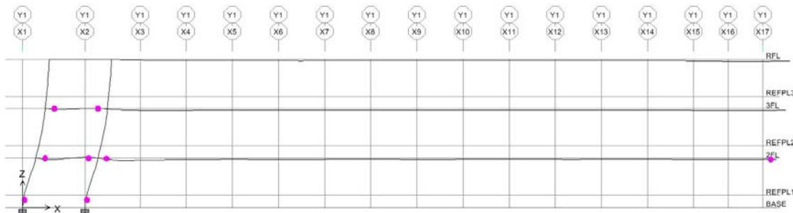
圖 C.63 X 向之 Y1 Frame(Deformed Shape-by PushX Static Nonlinear)
