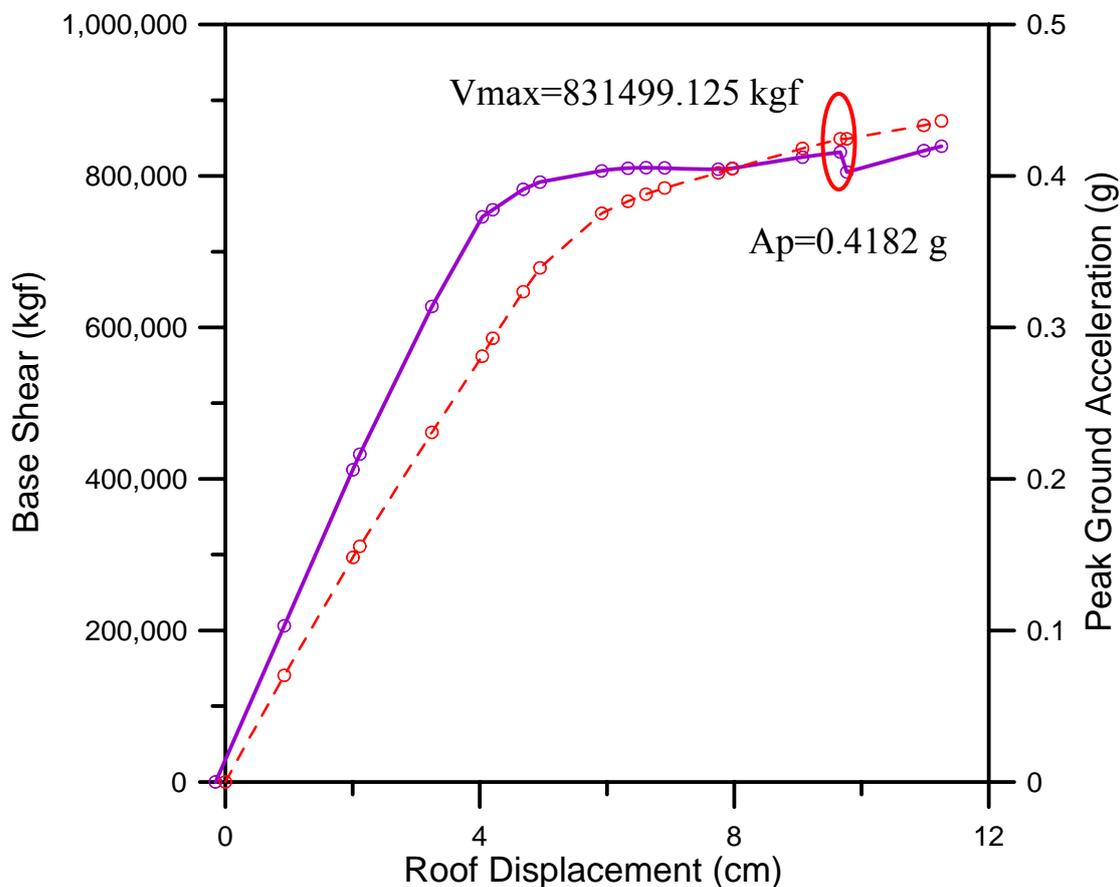
圖 C.73 Y 向容量曲線圖及性能目標地表加速度圖(含梁非線性鉸)
