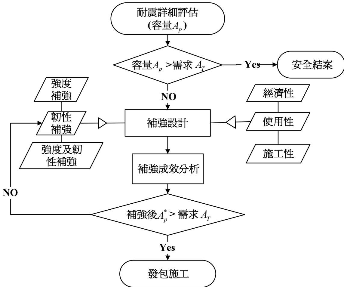
圖 5.2 耐震評估與補強流程圖
