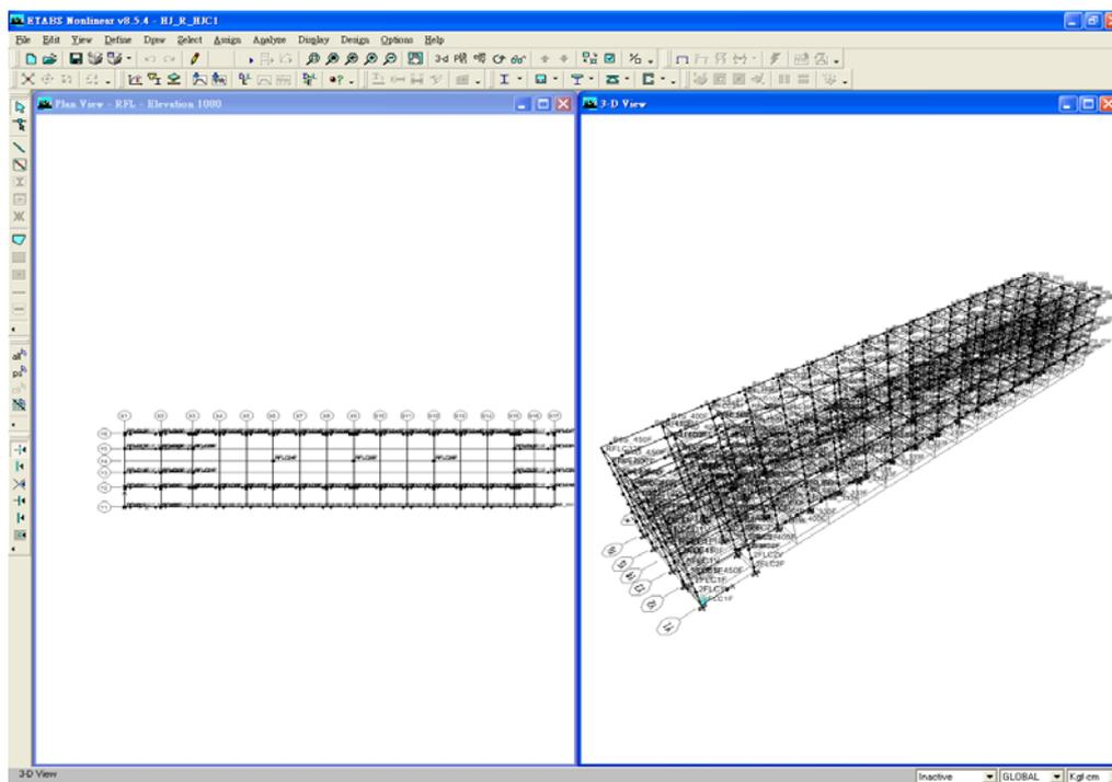
圖 C.111 案例校舍翼牆補強之 ETABS 程式 e2k 檔，檢查是否有非線性鉸產生
