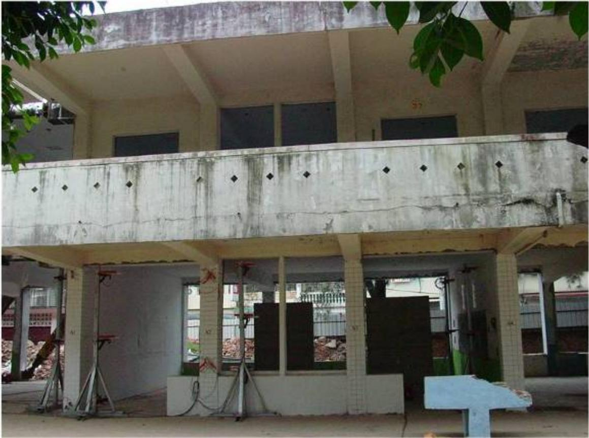
圖 70 瑞埔國小試體二試驗照片(破壞前)
