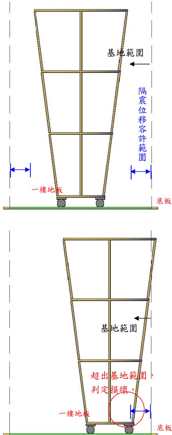
圖 5 隔震系統位移容許範圍示意圖
