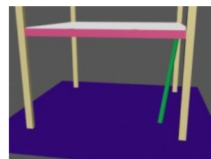
圖 11 模型內外斜撐說明
