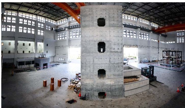
台南實驗室的長衝程高速度之振動台與雙軸向測試系統
