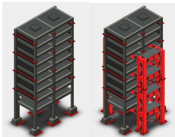
(a) 倒塌實驗大型試體外觀
