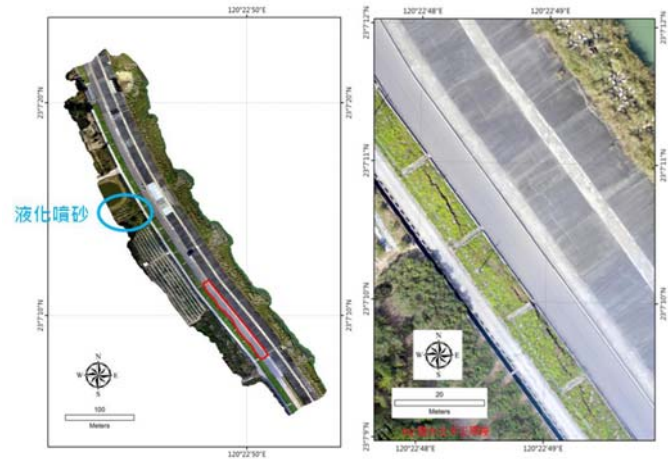
圖九 尖山堤防開裂破壞(王國隆提供)
