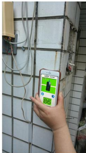
(B) 惠安街 161 巷 8 號建物 (C) 8 號房屋前傾角度量測
