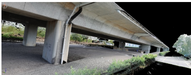
圖五 台 86 橋梁點雲 3D 掃描資料畫面
