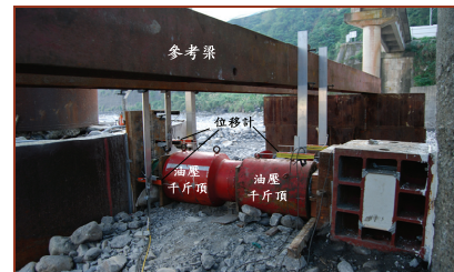
圖六 側推試驗施力系統與量測配置
