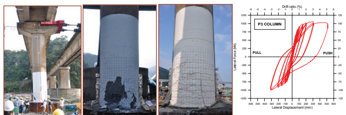
圖二 P3 橋墩試體破壞照片與實驗結果
