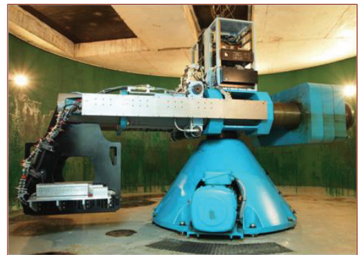
圖二 中央大學地工離心機暨振動台系統
