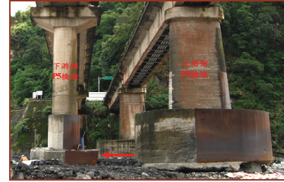
圖五 沉箱側推試驗示意
