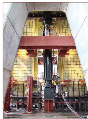
圖八 MATS 利用延伸功能進行鋼板剪力強試驗
