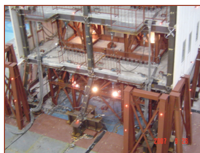
圖二 四層樓鋼構架試體破壞機制
