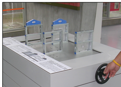
圖二十五 牆壁敲除及頂樓加蓋對結構耐震影響之手搖模型
