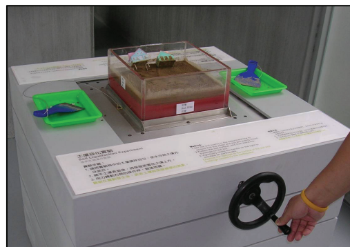
圖二十四 土壤液化手搖模型
