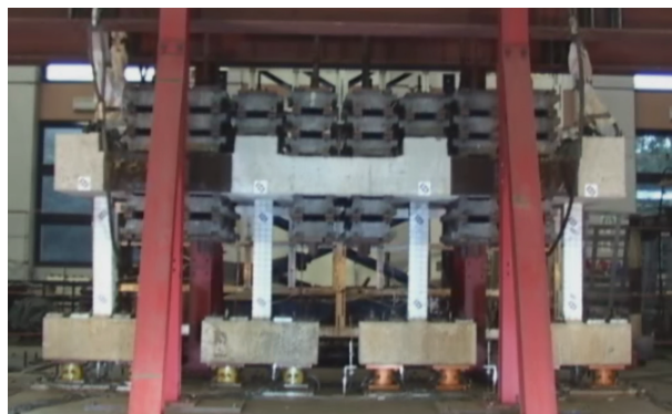
圖一 振動台崩塌實驗試體
