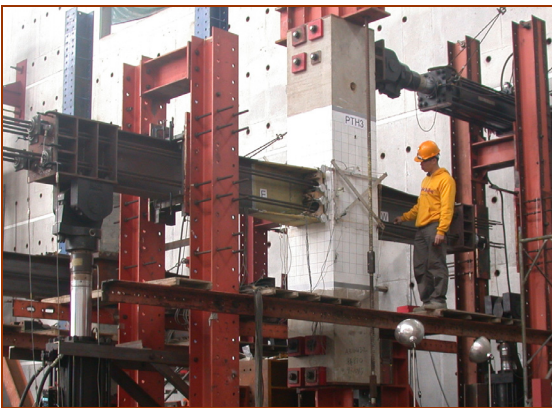
圖一 預力建築抗彎構架系統梁柱接頭之實際接合情形
