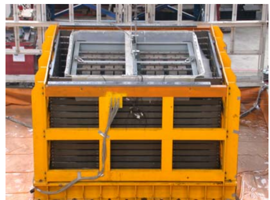
圖六 載重版加載於砂土試體之振動台試驗
