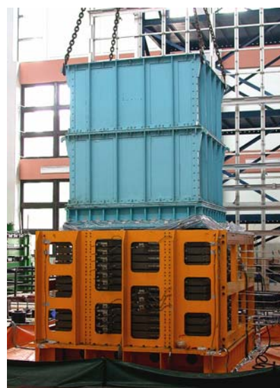
圖二 利用實落箱進行砂土試體準備情形
