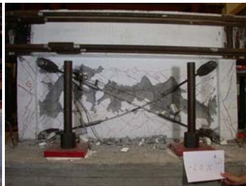
圖五 試體 SMAS 之破壞照片
